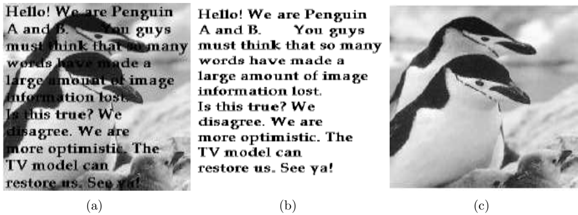
Figura 3.3: (a) Imagem sobreposta por um texto, (b) respectivo domínio de retoque e (c) Imagem reconstituída pelo método TV.
