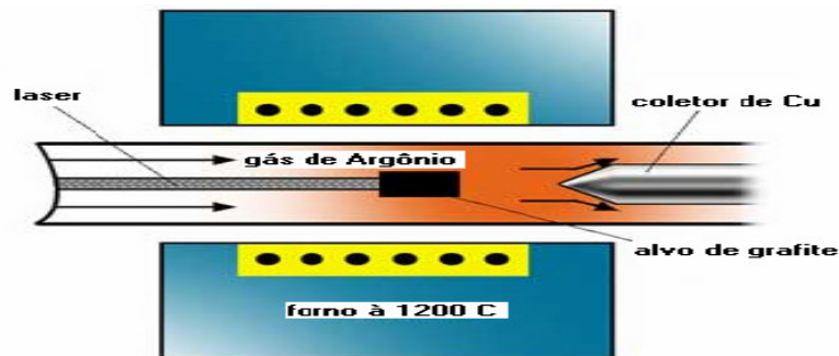
Fig.1.6- Método de Evaporação à Laser: Foi descoberto por Smalley ,em 1995.
