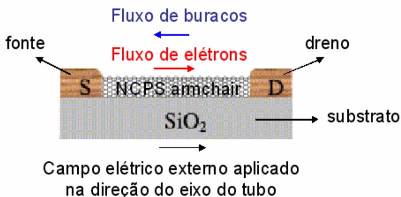
Fig. 3.12- Modelo sugerido de dispositivo molecular baseado em NCPS armchair. O campo elétrico externo aplicado na direção fonte-dreno indica que o dispositivo está polarizado diretamente e na direção contrária, o dispositivo está polarizado inversamente.
