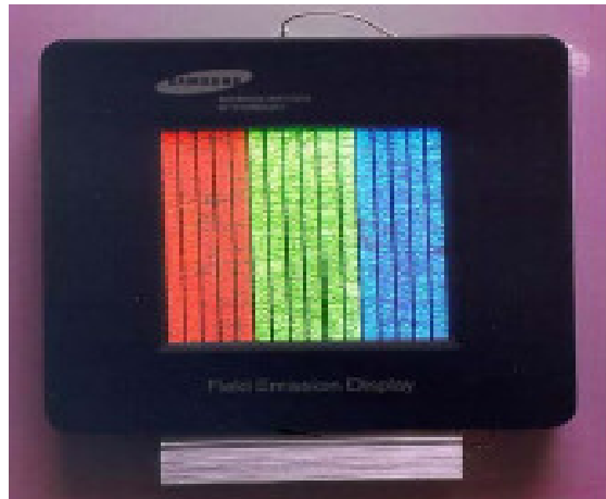
Fig. 1.43- Protótipo de um display de emissão de campo baseado em NCPS (Samsung Display Technology) [34].
