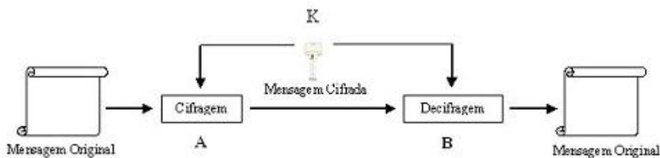
Figura 2.1: Sistema de Criptografia Simétrica
