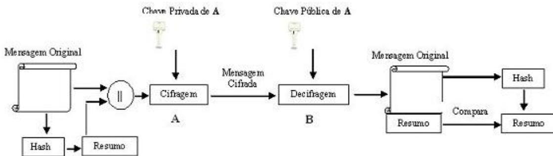
Figura 2.4: Assinatura Digital utilizando Função Hash
