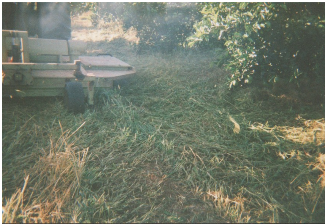
Figura 10 – Roçadeira enleiradora lateral em funcionamento em pomar de citros
