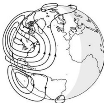
Figura 4.5: Correntes de plasma na ionosfera. Em baixas latitudes as correntes adotam movimentação paralela ao equador magnético.
