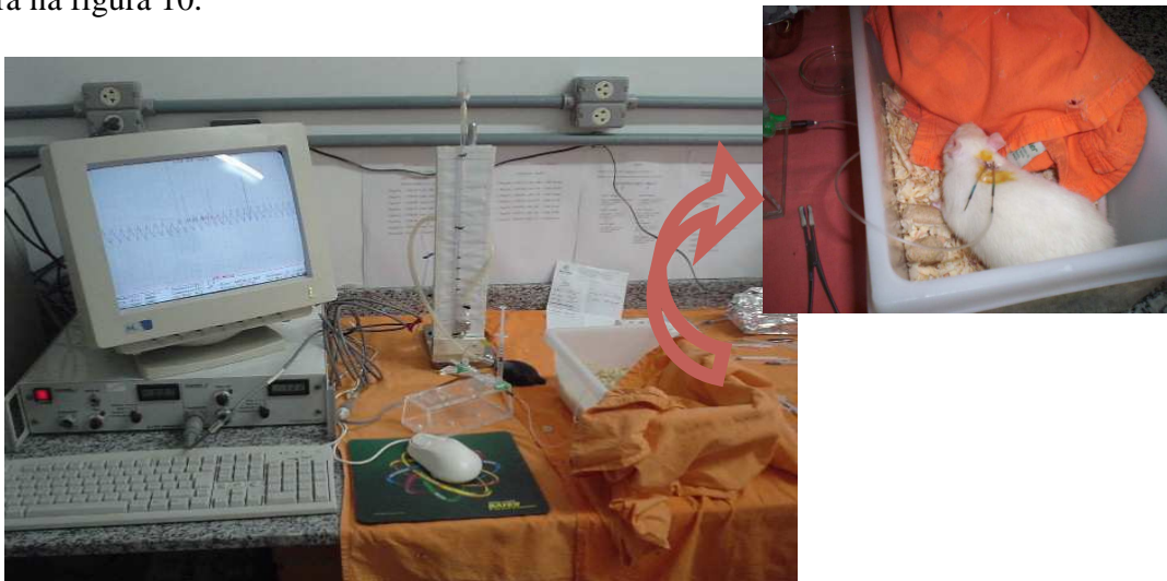
Figura 10: Ilustração da conexão entre a cânula e o transdutor eletromagnético e do sistema de registro de pressão arterial.
