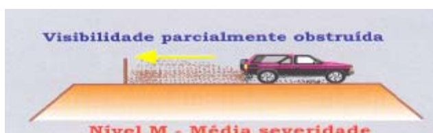
FIGURA 2.19: MÉDIO NÍVEL DE SEVERIDADE – EXCESSO DE POEIRA (BAESSO & GONÇALVES, 2003)
