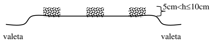
FIGURA 2.31: MÉDIO NÍVEL DE SEVERIDADE – PERDA DE AGREGADOS (EATON & BEAUCHAM, 1992)
