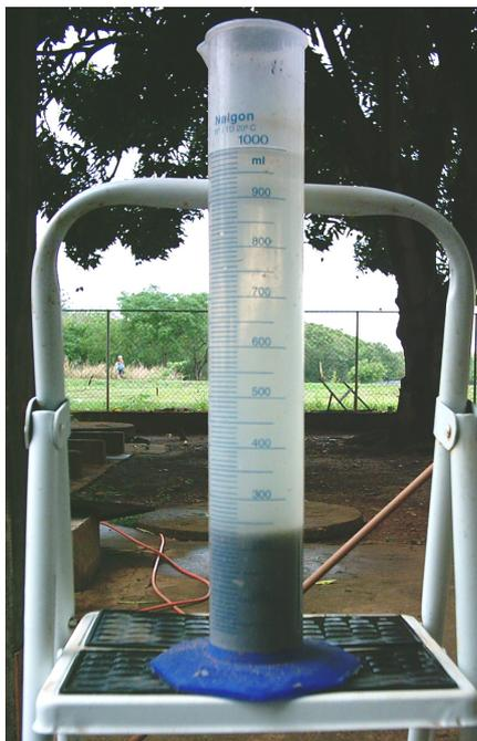
**Figura 20 – Proveta e volume sedimentado no ensaio de quantificação volumétrica da areia**
