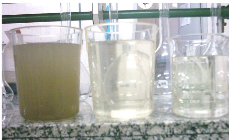
**Figura 34 – Aspecto do afluente e do efluente bruto e filtrado**
