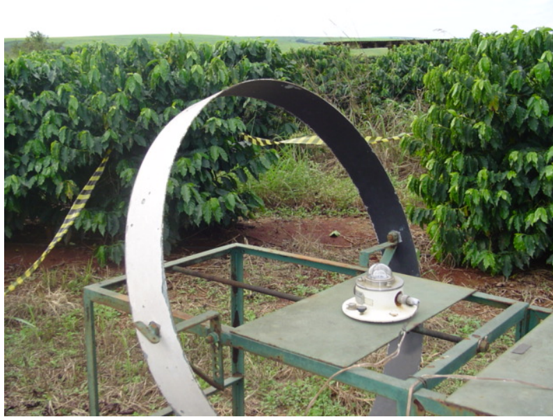
Figura 7 - Sistema para medida da radiação solar difusa dotado de uma banda metálica de sombreamento
