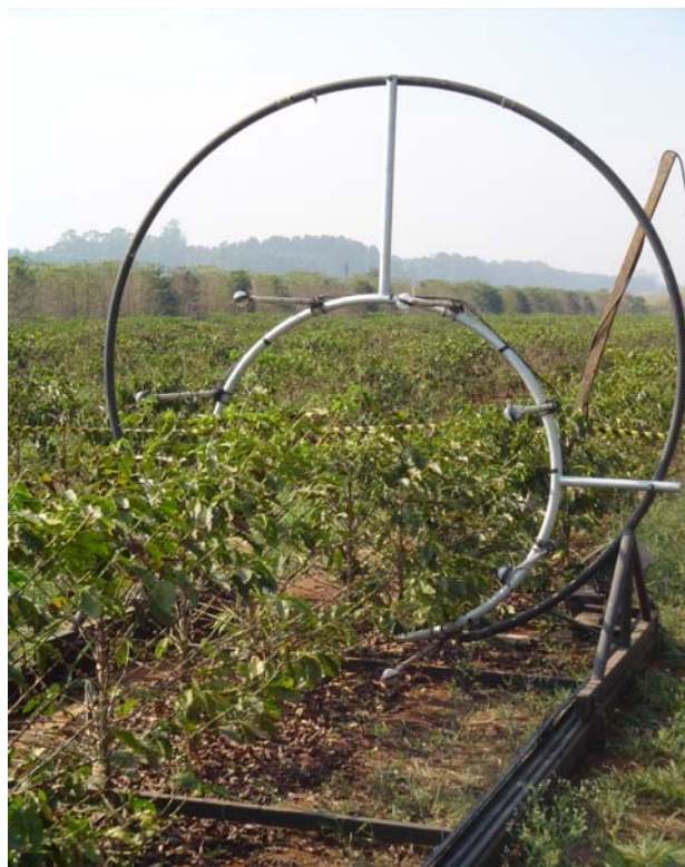
Figura 4 - Sistema de medida do saldo de radiação para renques de cafeeiros
