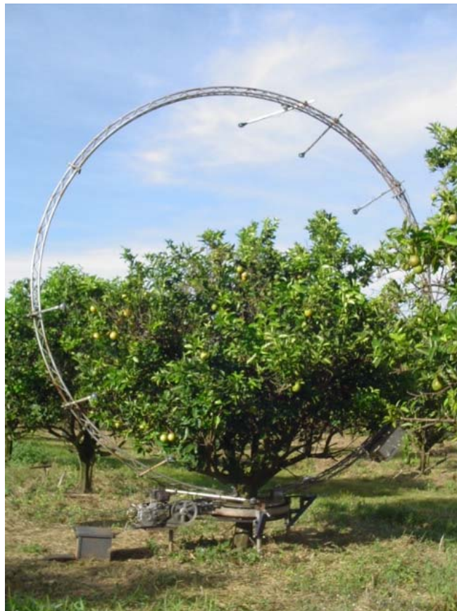
Figura 1 - Sistema de medida do saldo de radiação plantas isoladas
