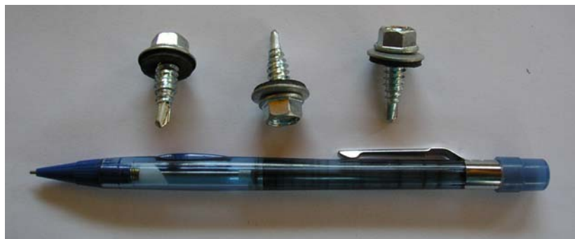
Figura 3.4 - Fixadores autoperfurantes zincados (1/4" x 7/8" com cabeça sextavada 3/8").
