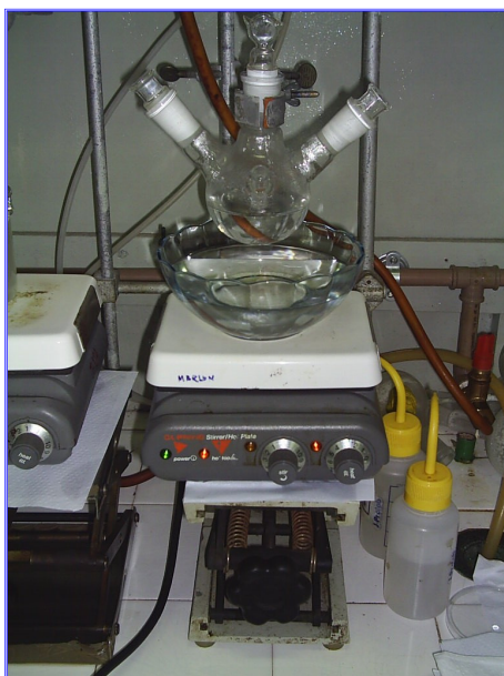
Figura 17 – Sistema utilizado para as reações de homopolimerização e copolimerização dos alcóxidos de silício.
