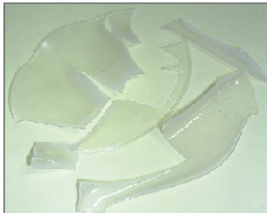
Figura 32 – Membranas de PVAI/TEOS (Razão 1/1) obtidas pelo processo sol-gel
