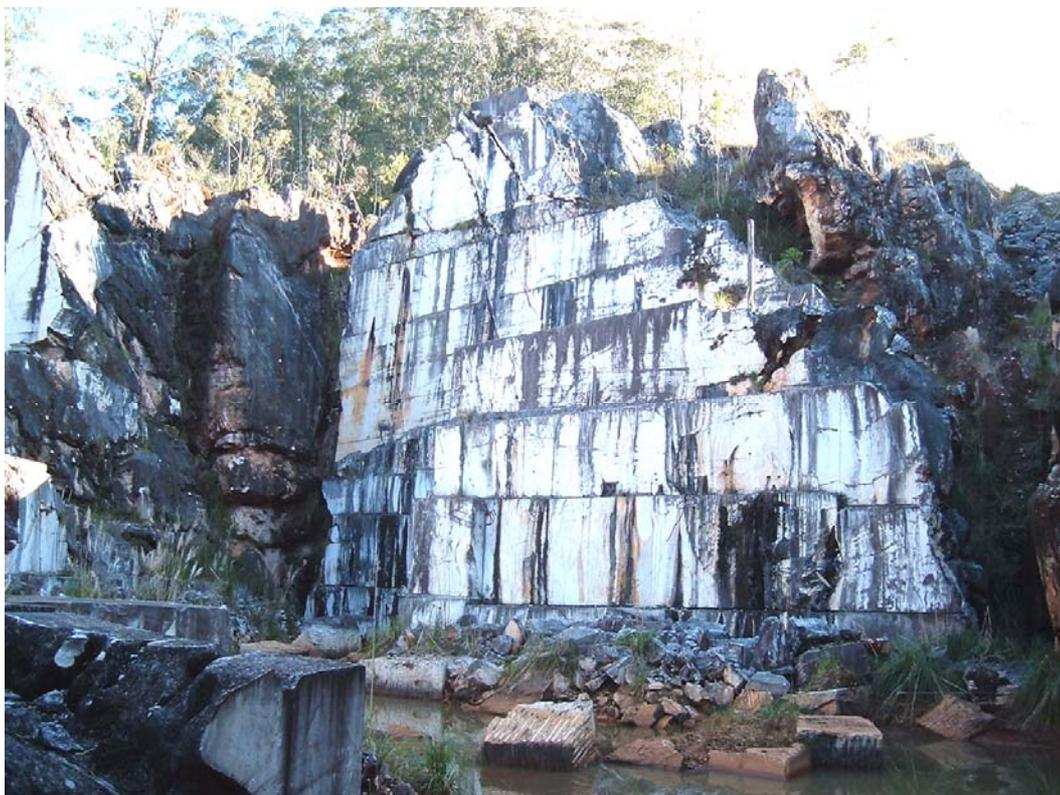
Figura 20 – Mármore maciços, granoblásticos, de coloração branca. Vila Capuava – Cerro Azul-PR- Mineradora Bau.
