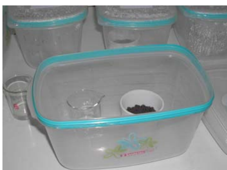
Figura 5 – Amostra de solo em presença de NaOH 0,5 M em recipiente hermeticamente fechado (A), e incubação do solo durante 10 dias para determinação do \text{CO}_2 (B).
