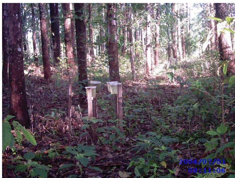
Figura 9 – Sistema de coleta de água de chuva.
