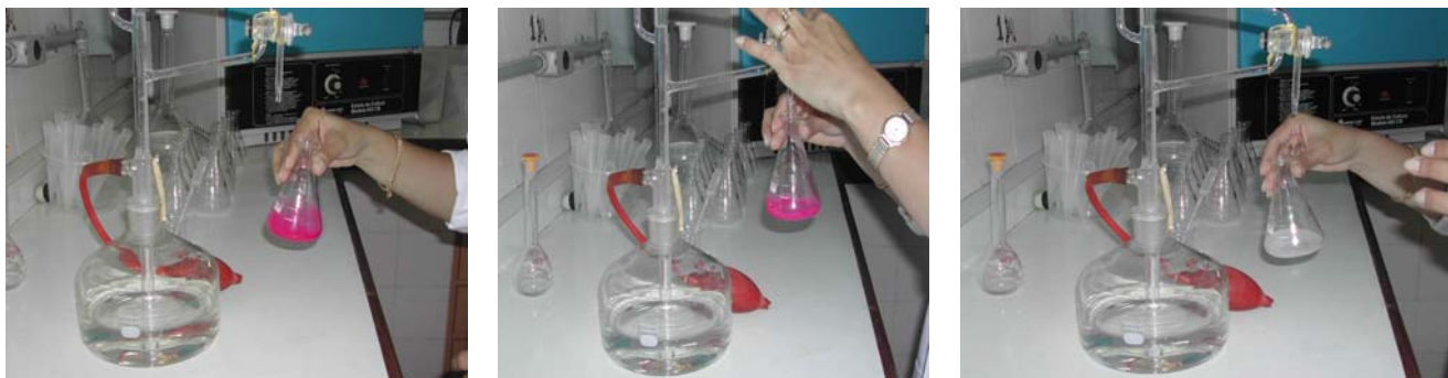
Figura 6 – Viragem na titulação com HCl 0,5 M.
