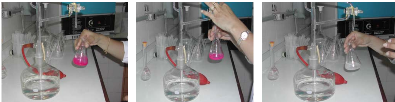
Figura 11 – Viragem na titulação com HCl 0,5 M.
