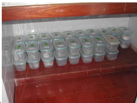
Figura 5 – Amostra de solo em presença de NaOH 0,5 M em recipiente hermeticamente fechado (A), e incubação do solo durante 10 dias para determinação do \text{CO}_2 (B).
