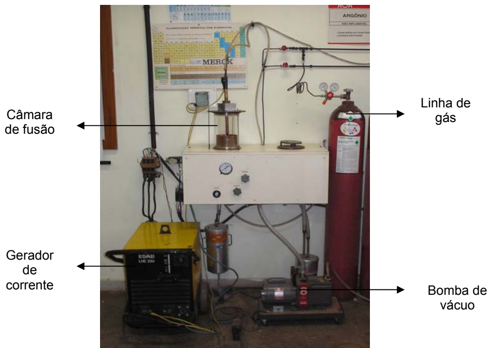
Figura 11 - Fotografia do forno a arco voltaico em funcionamento no LEMAG.
