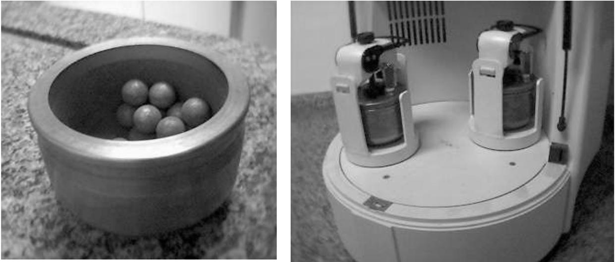
FIGURA 3.1.2: Jarro de moagem e seu posicionamento / fixação no interior do moinho planetário FRITSCH modelo Pulverisette 5.
