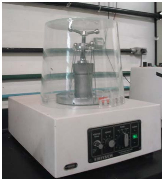
Figura 3.2 O moinho centrífugo FRISTCH P6 utilizado neste trabalho.
