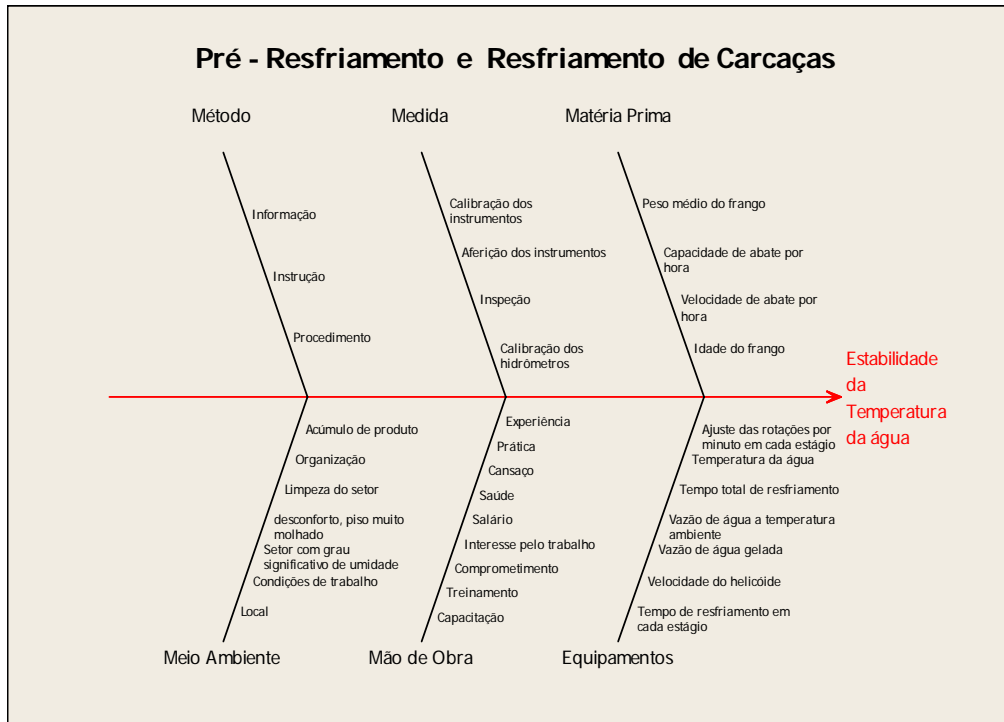
Figura 22: Diagrama de Ishikawa para a Identificação de interferências na Qualidade do Pré-resfriamento e Resfriamento de Carcaças de Frango de Corte.
