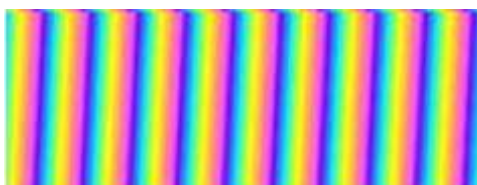
Figura 28 – Imagem codificada em cores da fase devida à terra plana Fonte: Nievinski e Sousa (2005)
