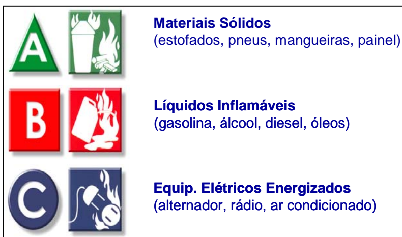
Figura 1 - Classificação dos extintores Fonte: Kidde Brasil
