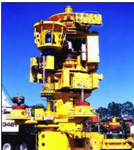
Ilustração 14 – Árvore de Natal Subsea
