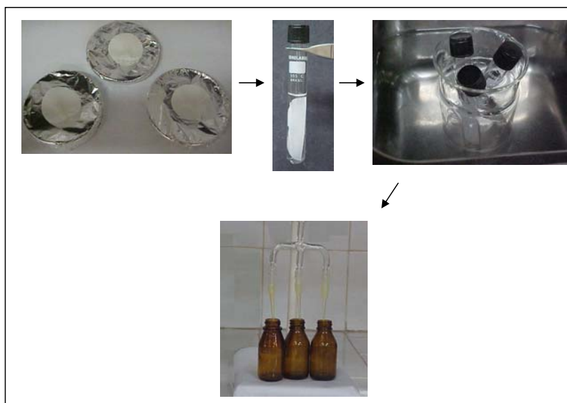
Figura 4 – Esquema do processo de extração dos HPAs dos filtros de membrana de policarbonato.
