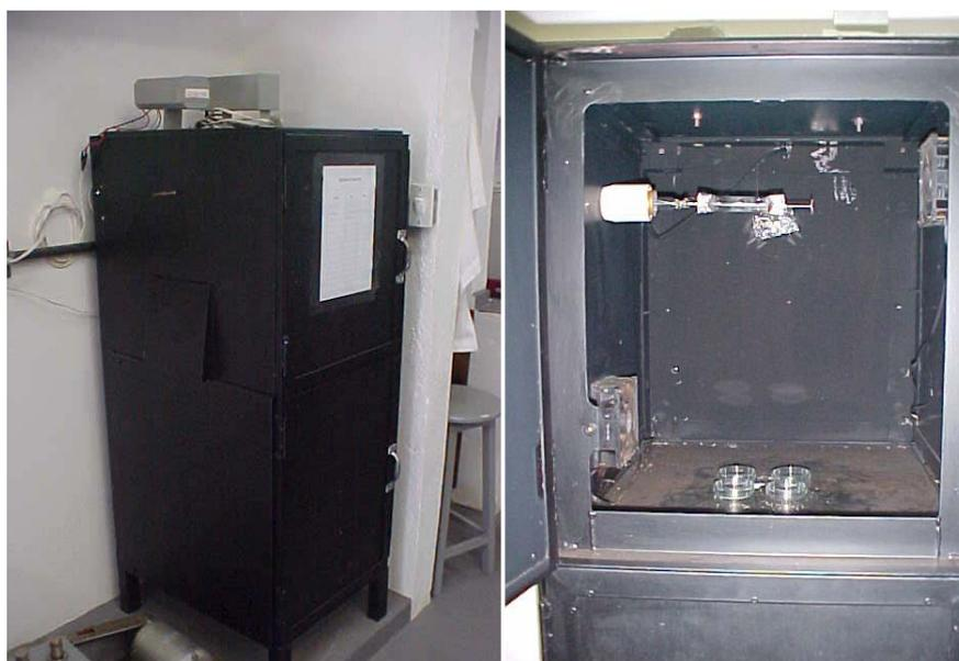
Figura 10 – Exposição das amostras à lâmpada de vapor de mercúrio
