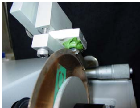
FIGURA 4.13 - Seccionamento longitudinal do espécime em máquina de corte
