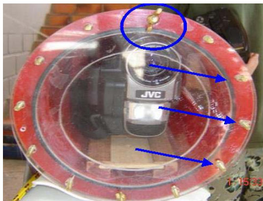
FIGURA 22: Destaque para os parafusos (setas) e para a porca do tipo borboleta (círculo).
