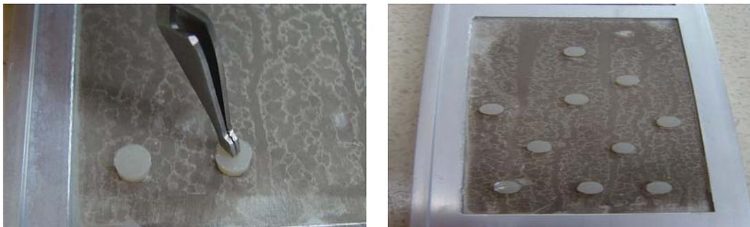
**FIGURA 11 (A-B)** -Corpos-de-prova sendo inseridos na placa e prontos para serem levados ao E.A.A.
