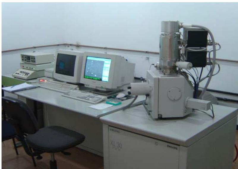
**FIGURA 5** - Microscópio eletrônico de varredura modelo XL-30 FEG.
