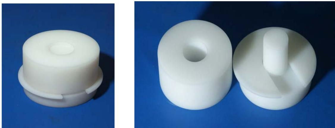
**FIGURA 8 (A-B)** - Matriz de teflon empregada na confecção dos corpos-de-prova composta, por base, haste central, anel e espaçador
