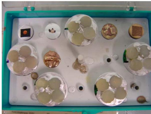
**FIGURA 13** – Stub de Alumínio onde os corpos-de-prova foram fixados
