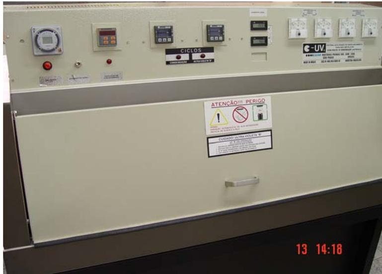
**FIGURA 4** – C-UV Sistema Acelerado de Envelhecimento para não metálicos.
