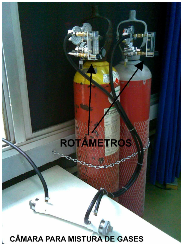
Figura 5.5: Foto mostrando o sistema mecânico com rotômetros, válvulas reguladoras de pressão e a câmara onde é inserido o sensor hidrogênio para teste.
