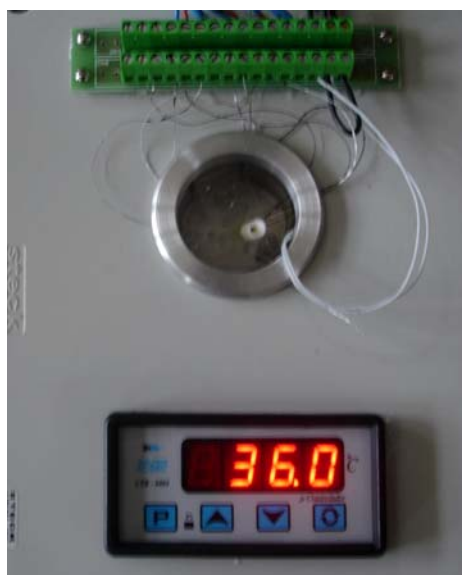
Figura 5 - Equipamento digital micro-processado para manter a estabilidade térmica
