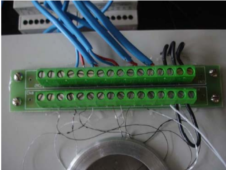
Figura 9 - Régua de borne : termopares ligados na extremidade inferior, cabos de compensação ligados na extremidade superior
