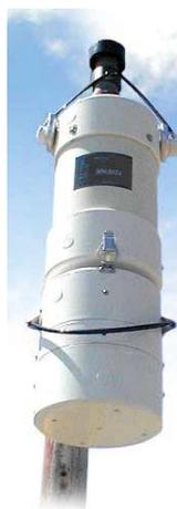
Figura 2.3: Ilustração do MiniVol, Coletor de PM<sub>10</sub>.
