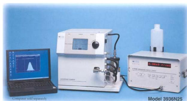
Figura 2.4: Foto do equipamento SMPS.
