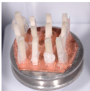
Figura 6. Palito fraturado montado para avaliação em MEV.
