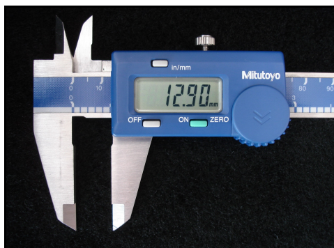
FIGURA 26: Paquímetro Eletrônico Digital Mitutoyo®, utilizado na obtenção das medidas lineares da mandíbula e dos biomodelos.
