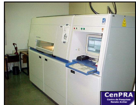
FIGURA 16: Aparelho de SLS (Sinterstation 2000 – DTM. EUA), pertencente ao LTDDP-CenPRA, Campinas-SP.
