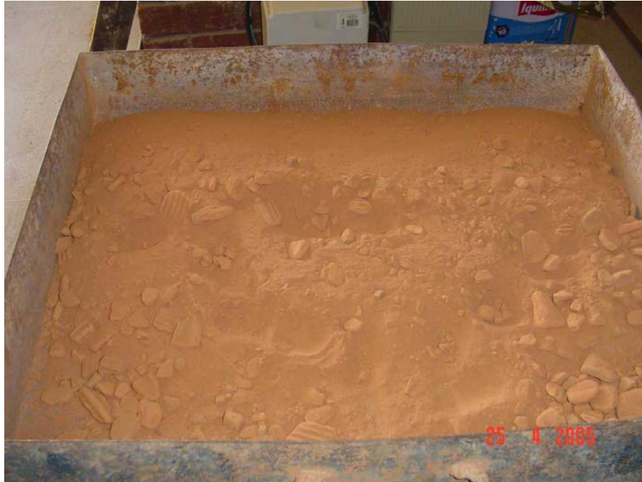
Figura 3.3: Resíduo Cerâmico após a britagem no Aparelho de Los Angeles.
