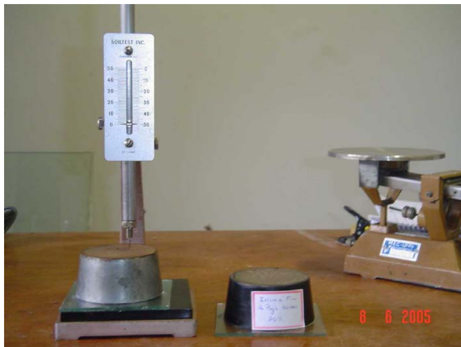
Figura 3.4: Ensaio de início e fim de pega utilizando o Aparelho de Vicat.
