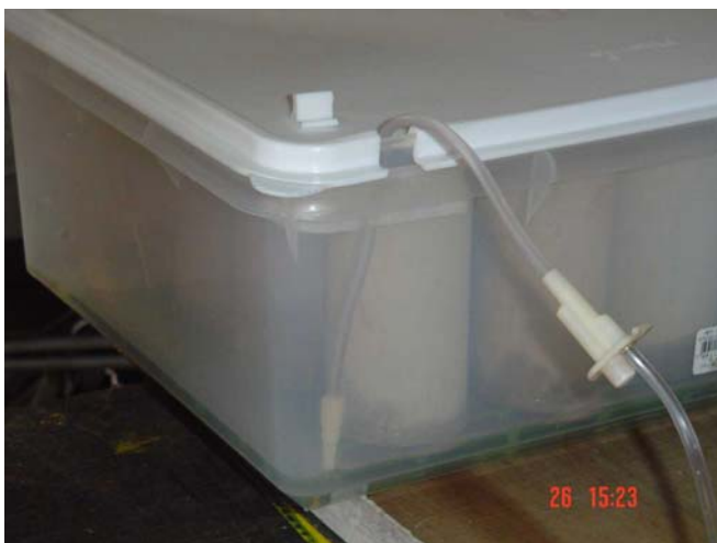
Figura 3.6: Controle do nível de água no ensaio de absorvidade.
