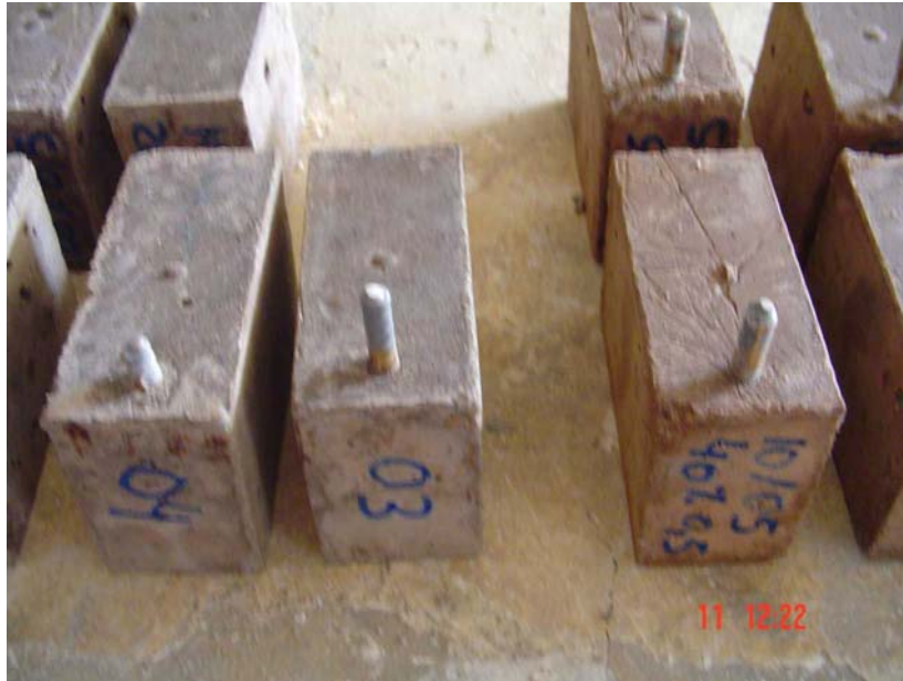
Figura 3.9: Corpos-de-Prova utilizados para as medidas eletroquímicas.
