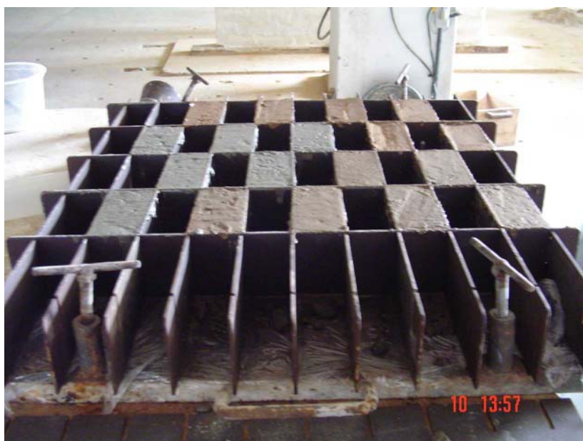
Figura 3.8: Moldagem dos corpos-de-prova utilizados para as medidas eletroquímicas.
