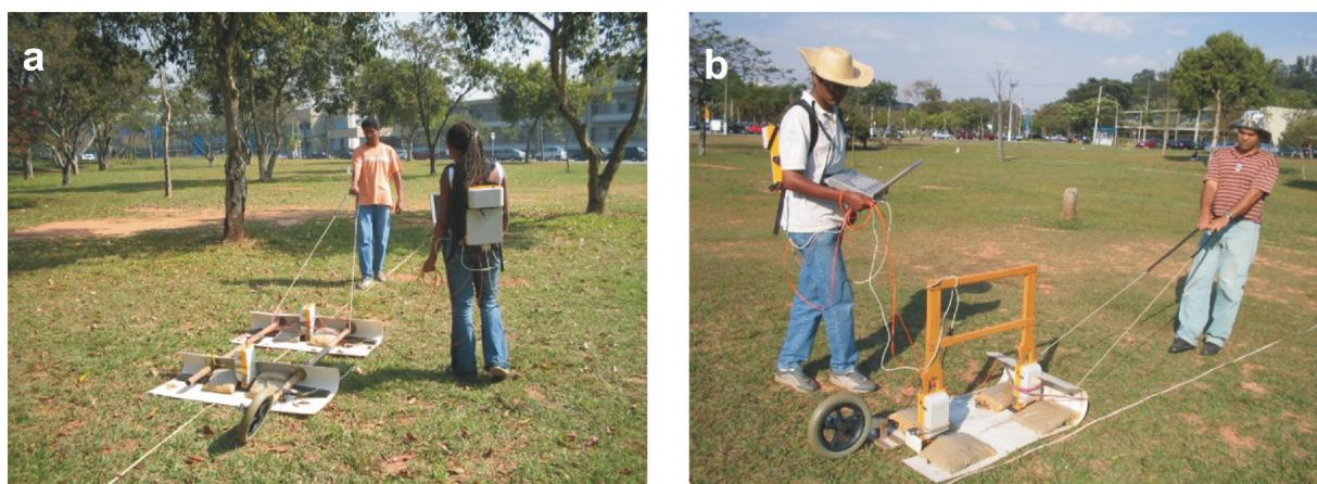
Figura 5.2 – Aquisições de campo no modo contínuo, a) arranjo Ey-Ey com antena de 100MHz, b) arranjo Ey-Ey com antena de 200MHz
