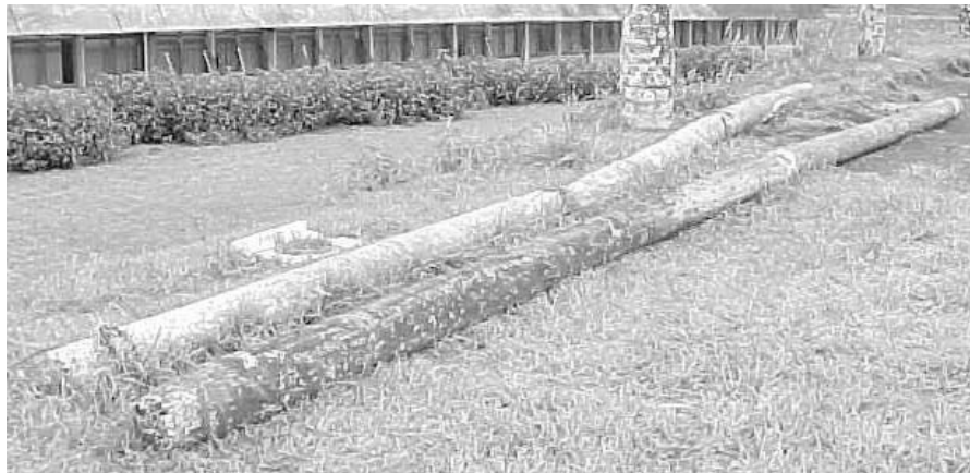
Figura 4.33 - Estacas A1(ON) e B9(SM) removidas
