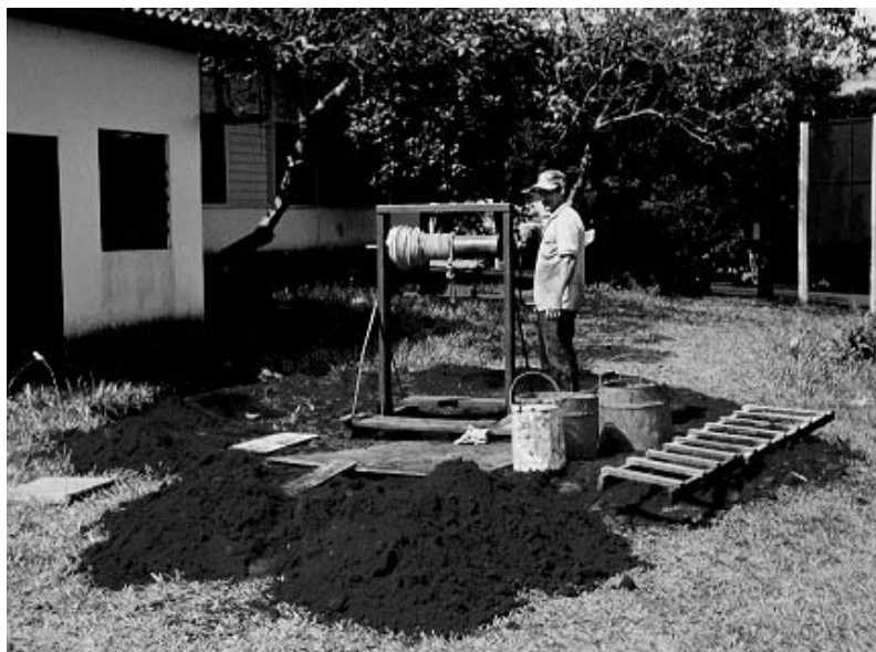
Figura 3.8 - Argila siltosa porosa característica do 1º estrato (P14)
