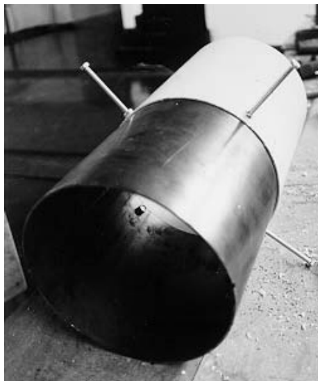
Figura 4.5 - Tubo de aço de cintamento e forma de PVC
