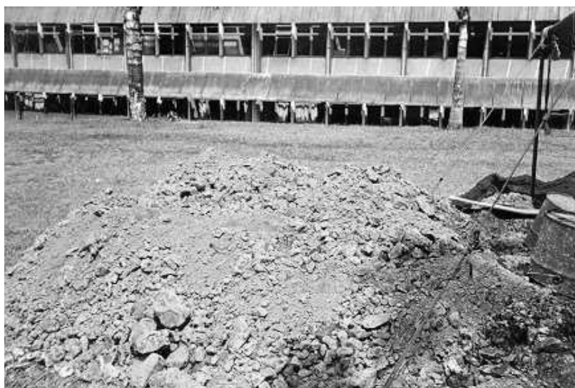
Figura 3.9 - Argila siltosa residual característica do 3º estrato (P9)
