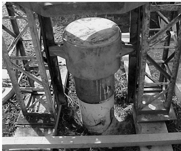
Figura 4.9 - Capacete e estaca instrumentada (VESSARO et al., 2004)
