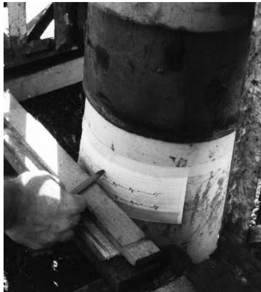
Figura 4.10 - Medidas de nega e repique (VESSARO et al., 2004)
