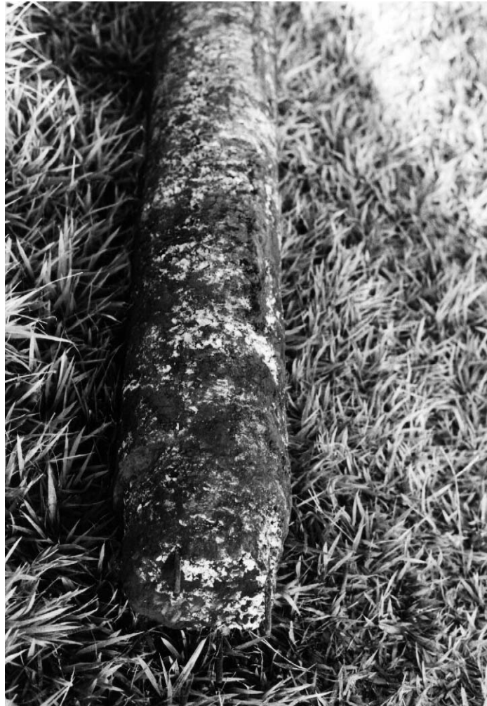
Figura 5.48 - Detalhe do trecho final da estaca A4(O)
