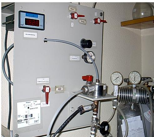
**Figura 20 – Sistema de Permeação de Gases do Laboratório de Membranas UERJ**
