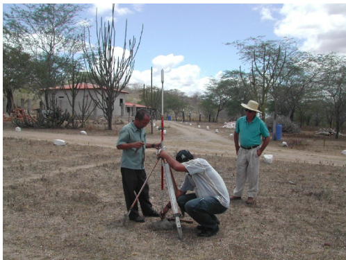
Foto 5.9- Instalação do geoprocessador base fixa Fonte: Menezes, 2004.
