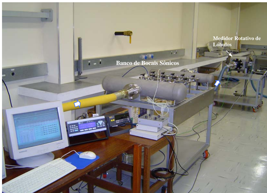
FIGURA 4.15 – Foto da montagem para calibração do medidor rotativo de lóbulos contra o BBS
