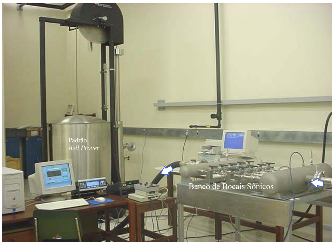
FIGURA 4.8 – Foto da seção de testes do sistema de calibração primário do Laboratório de Vazão de Gás do CETEC adaptado para calibração dos bocais sônicos instalados no BBS
