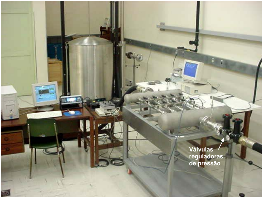
FIGURA 4.9 – Foto em outro ângulo da seção de testes do sistema de calibração primário do Laboratório de Vazão de Gás do CETEC adaptado para calibração dos bocais sônicos instalados no BBS, mostrando as duas válvulas de controle instaladas a montante do BBS
