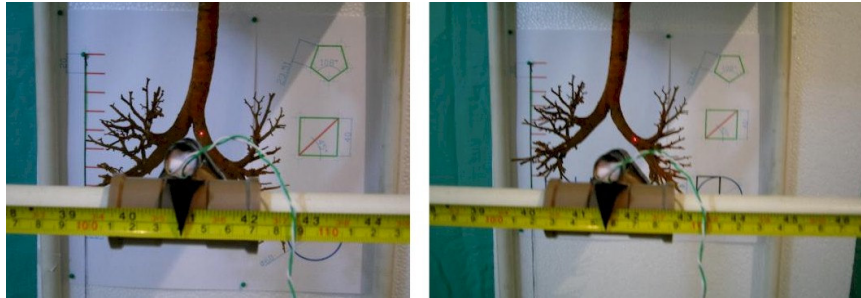
FIGURA 3.23 - Detalhe da medição das coordenadas do brônquio principal esquerdo
