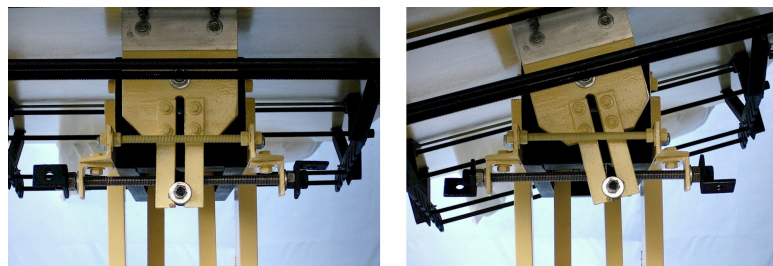
FIGURA 4.24 - Mecanismo para girar o protótipo em torno do eixo X
