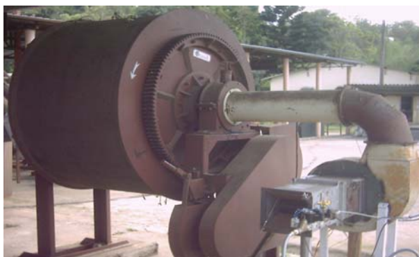
Figura 4 – Secador rotativo comercial com distribuição radial do fluxo de ar, unido ao gerador de calor.
