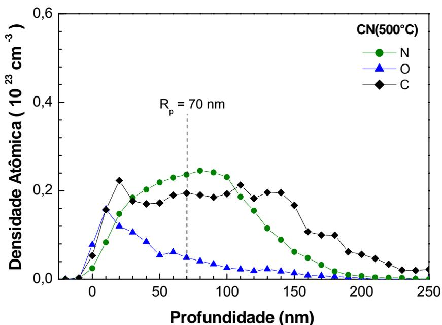
Figura 5.2-5 – Perfis ERDA obtidos para a amostra CN(500°C). Onde o círculo (●) mostra o perfil do nitrogênio, o triângulo (▲) mostra o perfil de oxigênio e o losango (◆) mostra o perfil de carbono.
