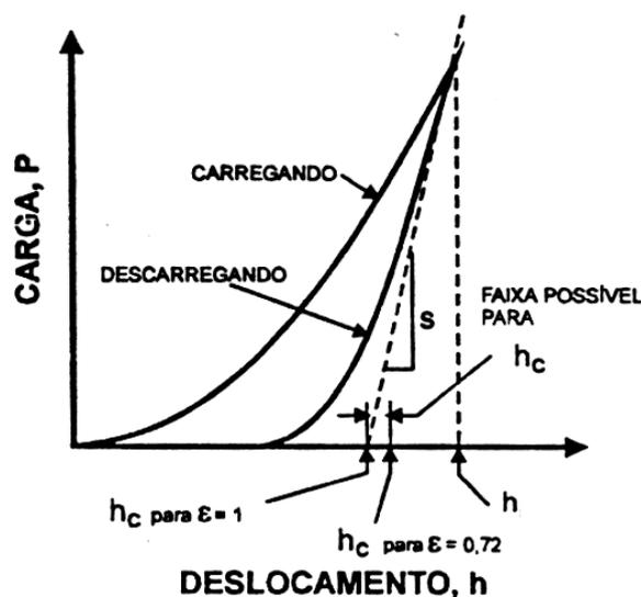
Figura 3.2-3 - Curva de carregamento e descarregamento, mostrando os parâmetros da penetração máxima da ponta, profundidade de contato  $h_c$ , profundidade final  $h_f$ , a rigidez  $S$  e a recuperação elástica [14].
