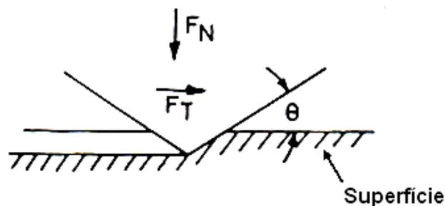
Figura 3.3.6 – Modelo muito simplificado do desgaste abrasivo, mostrando como uma aspereza cônica remove material de uma superfície [77]. Onde  $F_T$  é a força tangencial,  $F_N$  é a força normal ou carga aplicada e  $\theta$  é o ângulo de inclinação das asperezas cônicas.
