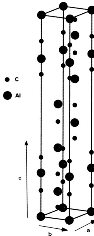
Figura 2.2-1 – Estrutura do  $\text{Al}_4\text{C}_3$  com os parâmetros de rede  $a \approx 0,855$  nm e  $\alpha \approx 22^\circ 28'$ .
