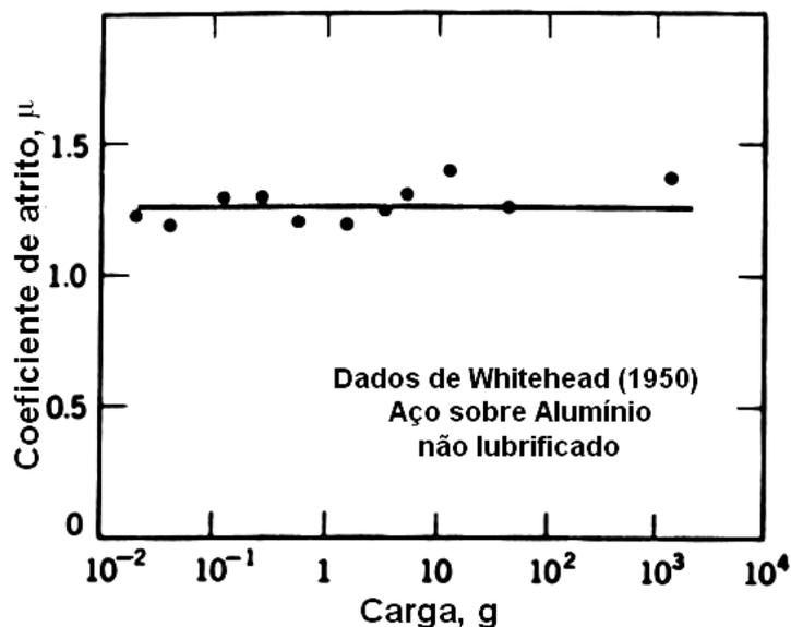
Figura 3.3-1 - Atrito de aço sobre o alumínio, onde o coeficiente de atrito independente da carga aplicada [77].
