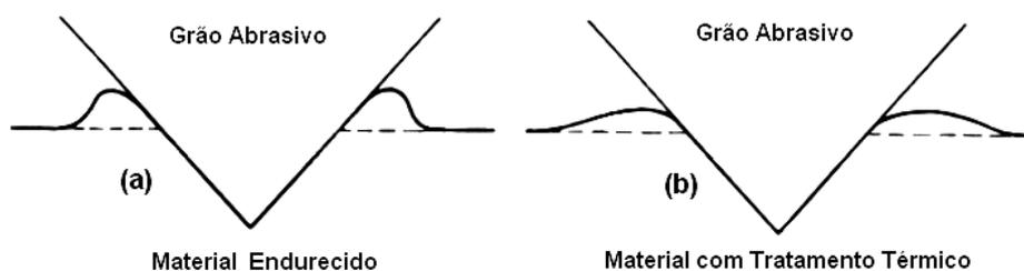
Figura 3.3-3 – Formação de sulcamento em um material duro e em um outro com tratamento térmico [77]. Os grãos abrasivos são asperezas existentes nas superfícies dos materiais. Um grão abrasivo pode indentar a superfície de um material provocando os sulcamentos no formato de “onda”, como no caso (a) e (b). No caso (a) verifica-se que o sulcamento apresenta-se mais espalhado do que em (a).
