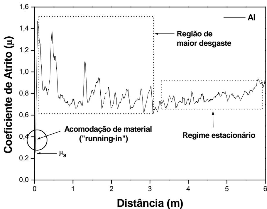
Figura 5.7-1– Coeficiente de atrito x distância de deslizamento para a amostra de alumínio policristalino, na qual estão identificados os estágios de deslizamento.
