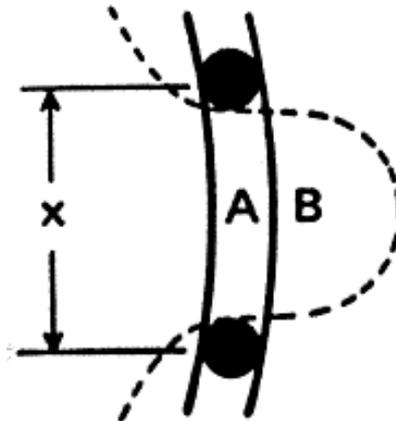
Figura 6.4-4 – Cisalhamento dos precipitados pelo movimento de discordâncias [52, 55].
