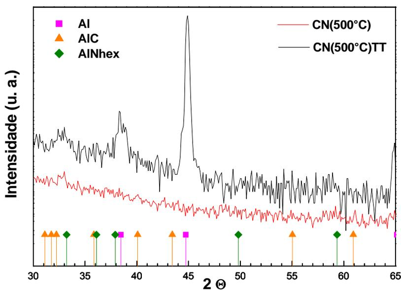
Figura 5.1-1 – Padrões de difração de raios-X em ângulo de incidência rasante de  $2^\circ$  para as amostras CN(500°C) e CN(500°C)TT. Os quadrados ( ) indicam a posição dos picos do alumínio, os triângulos (▲) indicam as posições dos picos do  $\text{Al}_4\text{C}_3$  e os losangos (◊) indicam a posição dos picos do AlN com estrutura hexagonal compacta.
