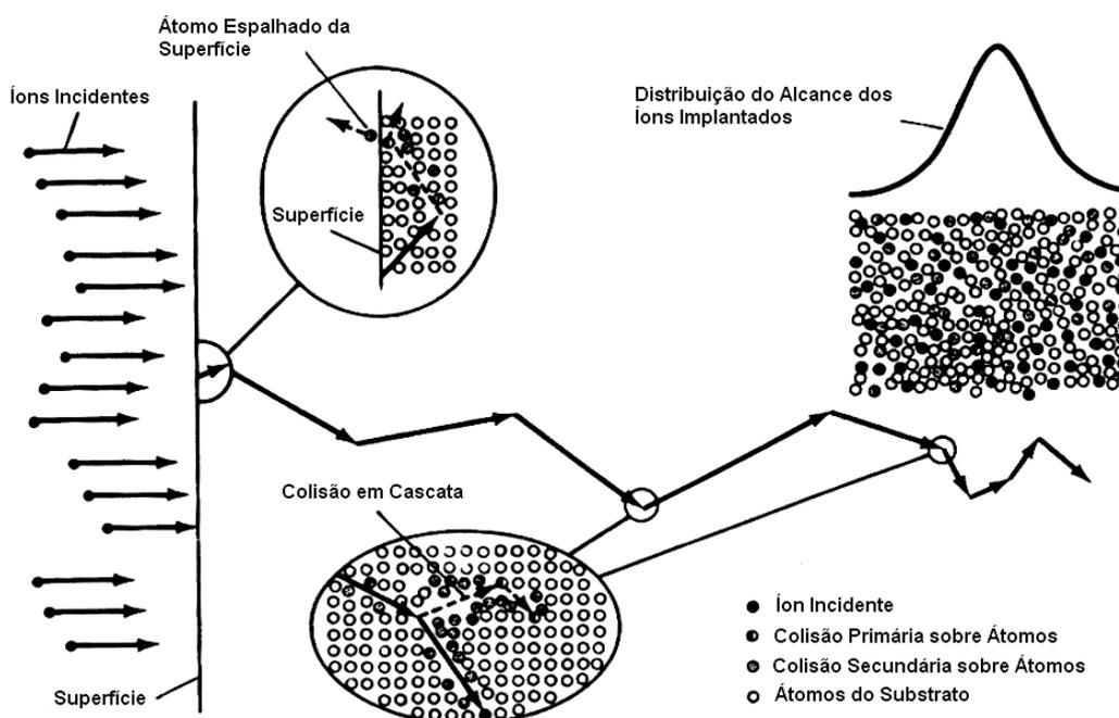
Figura 3.1-1 – Representação esquemática do fenômeno da implantação iônica [48].
