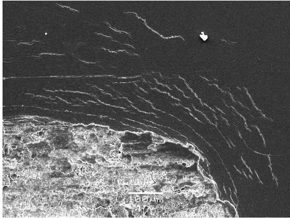
Figura 6.6-3- Ampliação da região superior direita da amostra NC(RT)TT mostrando as macrobandas de deslizamento.
