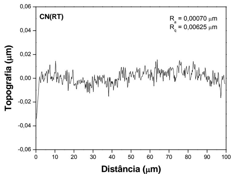
Figura 5.5-1 – Perfil de rugosidade obtida para a amostra CN(RT).
