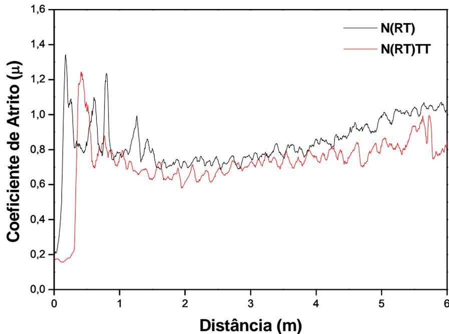
Figura 5.7-3 – Coeficiente de atrito x distância de deslizamento para as amostras N(RT) e N(RT)TT.
