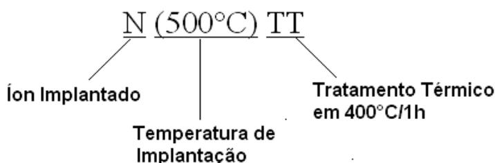
Para o estudo da estabilidade térmica dos precipitados formados pela implantação iônica foi estabelecida a temperatura de 400 °C por um tempo de uma hora e em vácuo da ordem de  $10^{-4}$  Pa.
