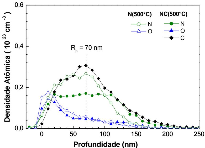
Figura 5.2-4 – Perfis ERDA obtidos para as amostras N(500°C) e NC(500°C). Onde os círculos (●,○) mostram os perfis do nitrogênio, os triângulos (▲,△) indicam os perfis de oxigênio e o losango (◆) mostra o perfil de carbono. As simbologias vazias indicam que são os perfis dos elementos correspondentes à amostra N(RT), enquanto que as cheias são para a amostra NC(RT).
