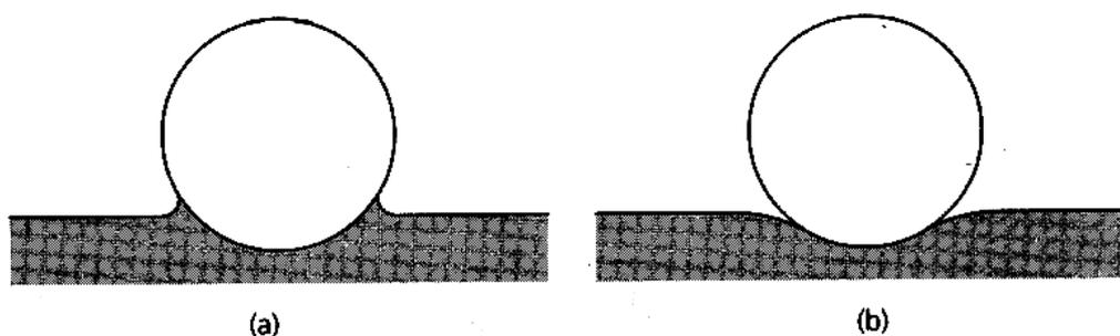
Figura 3.2-1 – (a) Empilhamento (“pileup”) e (b) Afundamento (“sinking”) [57].
