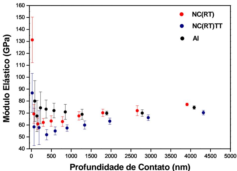
Figura 5.6-1 – Módulo de elasticidade x profundidade de contato para as amostras NC(RT) e NC(RT)TT.
