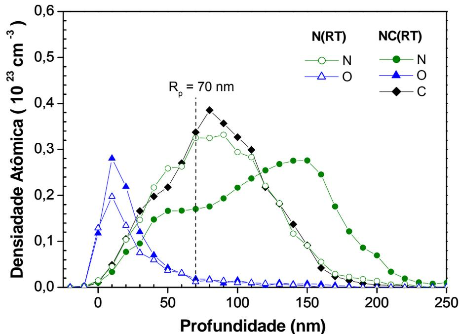
Figura 5.2-2 – Perfis ERDA obtidos para as amostras N(RT) e NC(RT). Onde os círculos (●,○) mostram os perfis do nitrogênio, os triângulos (▲,△) indicam os perfis de oxigênio e o losango (◆) mostra o perfil de carbono. As simbologias vazias indicam que são os perfis dos elementos correspondentes à amostra N(RT), enquanto que as cheias são para a amostra NC(RT).
