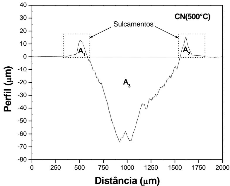
Figura 4.8.1 – Perfil obtido de uma seção transversal da trilha desgastada para a amostra CN(500°C).
