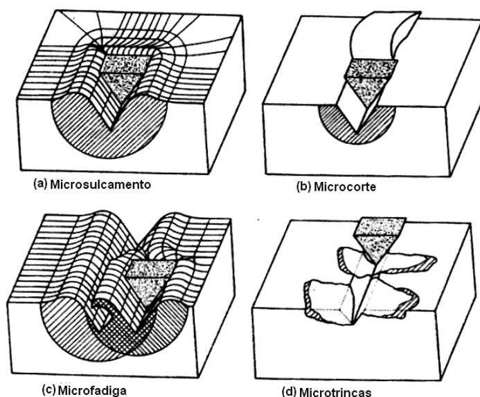
Figura 3.3-5 – Interações físicas entre partículas abrasivas e superfícies de materiais. (a) Microsulcamento, (b) microcorte, (c) microfadiga e (d) microtrincas [72].
