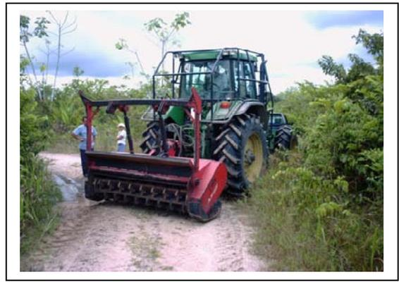
Figura 01: Tritucap (à esquerda) e fresadora AHWI (à direita) ambos acoplados a um trator.
