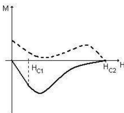
Figura 3.9: Magnetização de supercondutor do tipo II em materiais reais.
