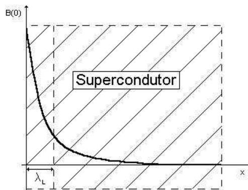
Figura 3.10: Penetração do fluxo magnético no interior de um supercondutor.
