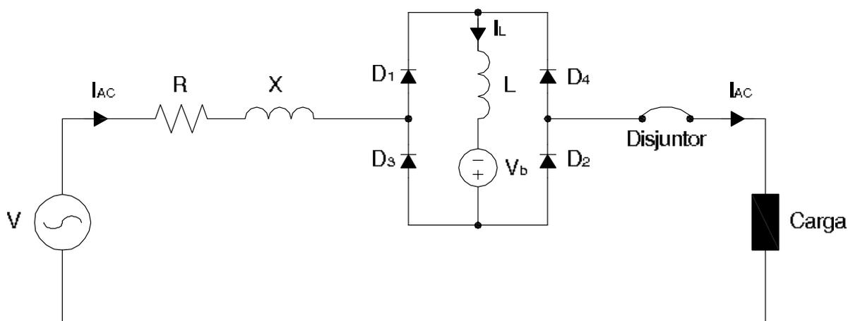
Figura 2.11: Circuito elétrico equivalente de DLCFS do tipo ponte.
