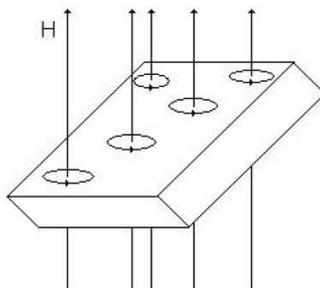
Figura 3.6: Estado misto, mostrando os vórtices de supercondutores.
