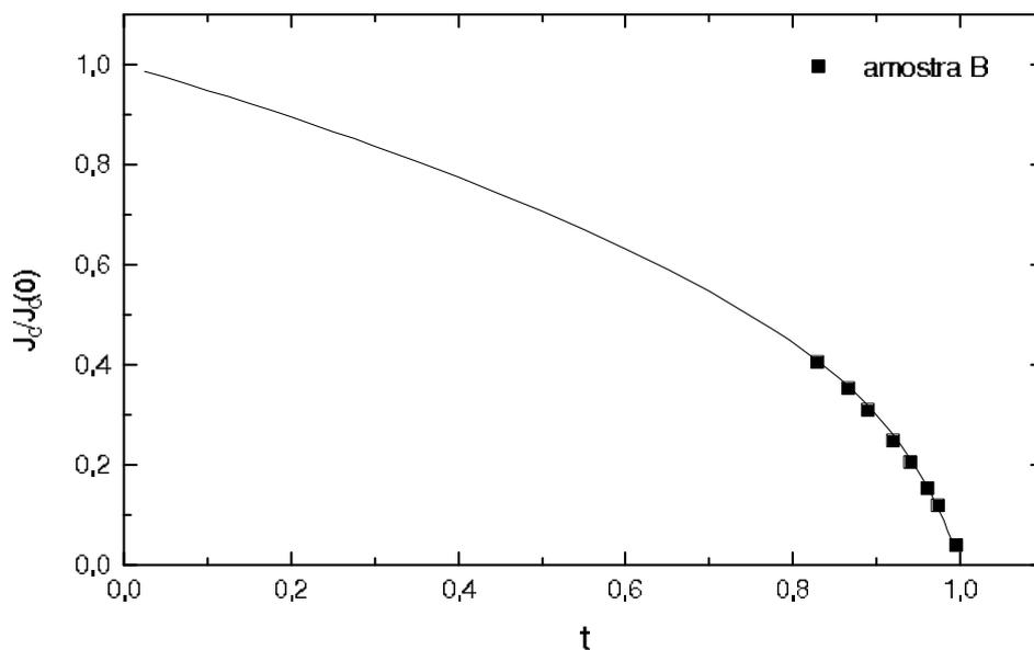
Figura 4.2: Densidade de corrente crítica normalizada ( $J_c/J_c(0)$ ) em função da temperatura normalizada ( $T/T_C^*$ ) da amostra B.
