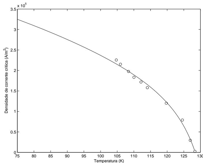
Figura 5.4: Densidade de corrente crítica ( $J_C$ ) em função da temperatura ( $T$ )
