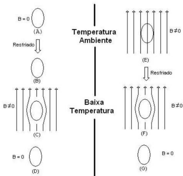
Figura 3.4: Comportamento magnético de um supercondutor.
