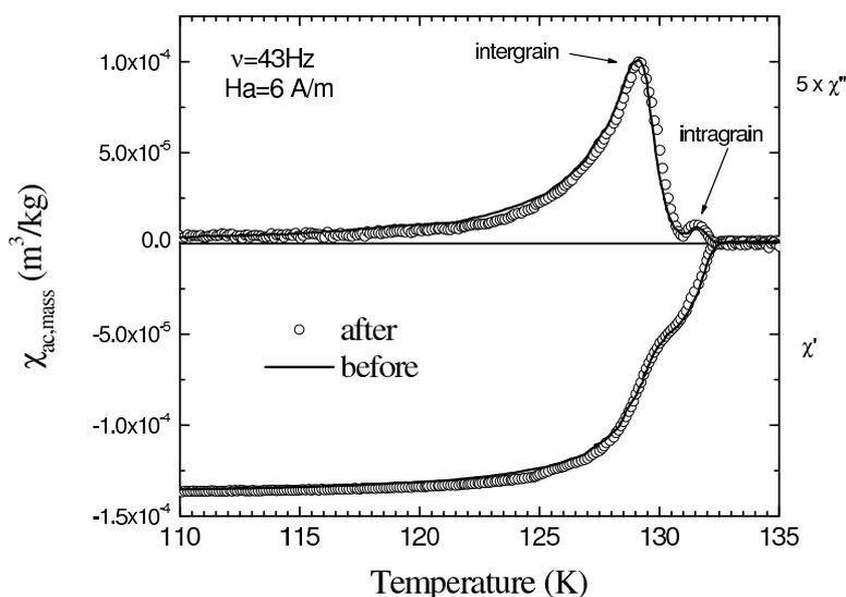
Figura 6.7: Susceptibilidade magnética AC antes e depois dos testes.
