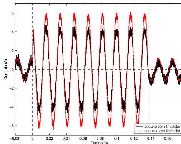
Figura 6.4: Ensaio de curto circuito com o limitador de corrente  $R_{carga} = 20\Omega$ ,  $R_{falta} = 4\Omega$  e restauração da condição normal de operação.
