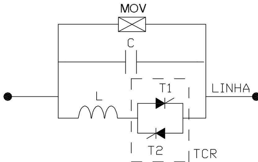
Figura 2.5: Esquema de um dispositivo TCSC.
