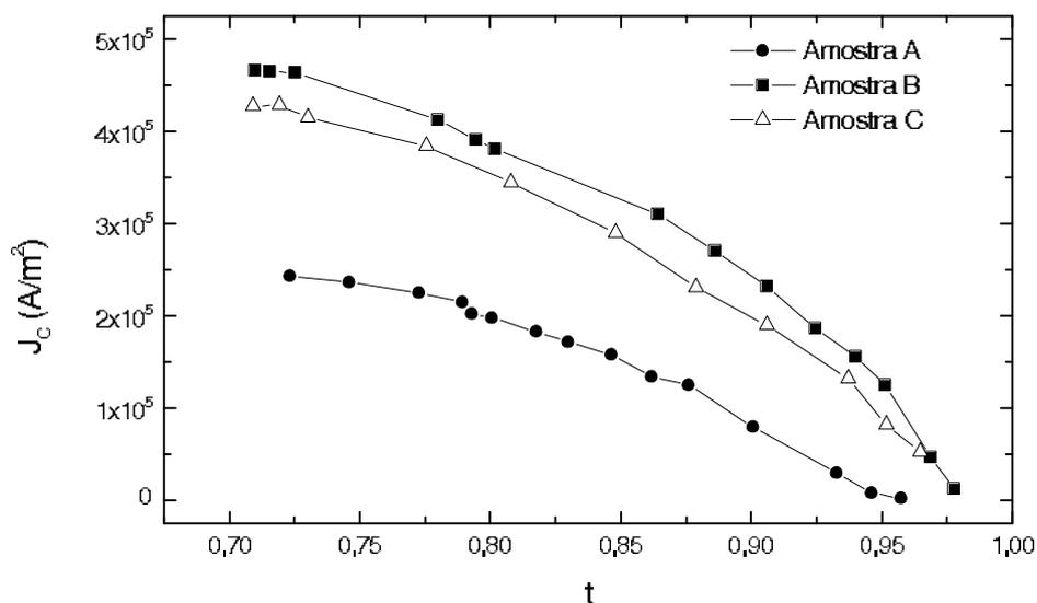
Figura 4.1: Curva da dependência da densidade de corrente crítica em função  $t(T/T_C^*)$  para amostras com diferentes teores de oxigênio.
