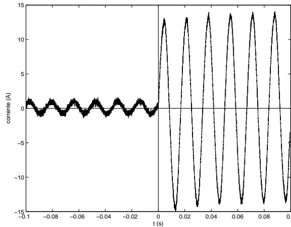
Figura 6.2: Ensaio de um curto circuito sem o limitador de corrente.
