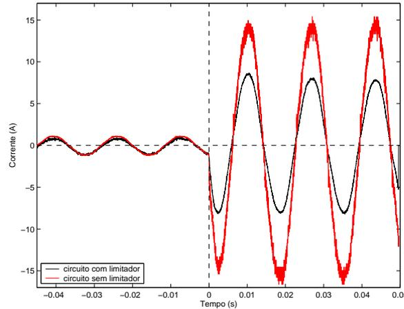
Figura 6.5: Ensaio de curto circuito com o limitador de corrente  $R_{carga} = 20\Omega$  e  $R_{falta} = 1\Omega$ .
