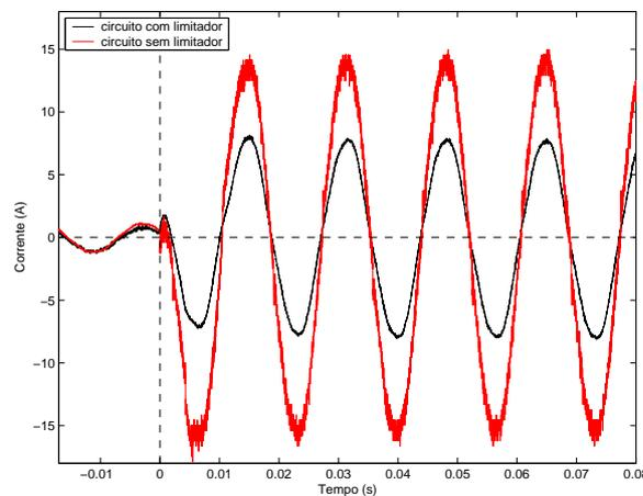
Figura 6.6: Ensaio de curto circuito com o limitador de corrente  $R_{carga} = 20\Omega$  e  $R_{falta} = 1\Omega$  e falta em outro ponto da senóide da tensão de alimentação.
