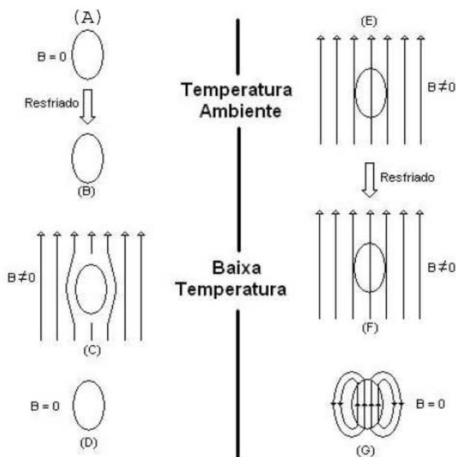
Figura 3.3: Comportamento magnético de um condutor perfeito.
