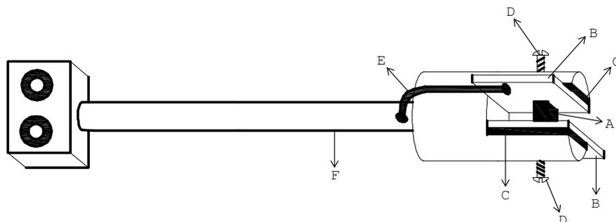
Figura 5.7: Ponta de fixação da cerâmica supercondutora com a haste.
