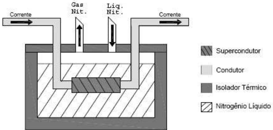
Figura 2.8: Limitador de corrente de falta supercondutor do tipo resistivo (DLCFS).
