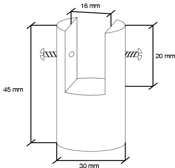
Figura 5.6: Ponta de fixação da cerâmica supercondutora.
