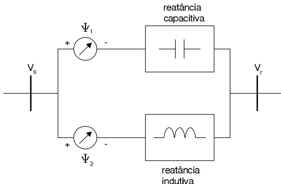
Figura 2.7: Circuito equivalente do IPC com 2 ramos.
