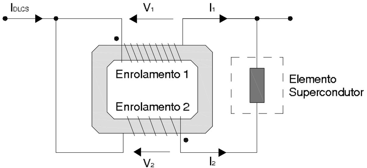
Figura 2.12: DLCFS do tipo fluxo fechado.
