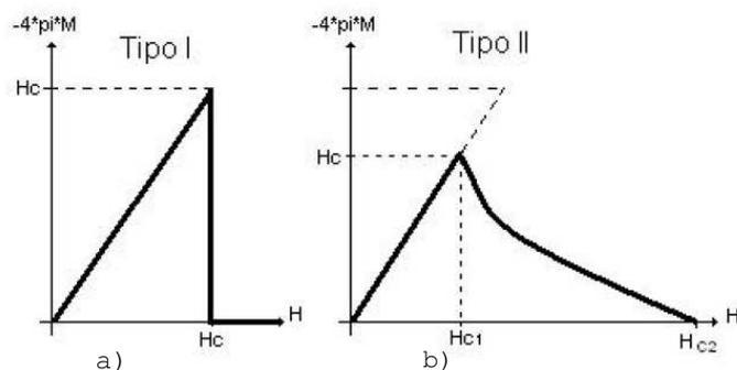
Figura 3.5: Variação da magnetização em função do campo magnético em materiais supercondutores do tipo I(a) e tipo II(b).
