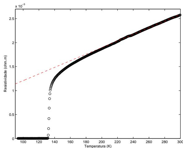
Figura 5.5: Resistividade ( $\rho$ ) em função da temperatura ( $T$ ).
