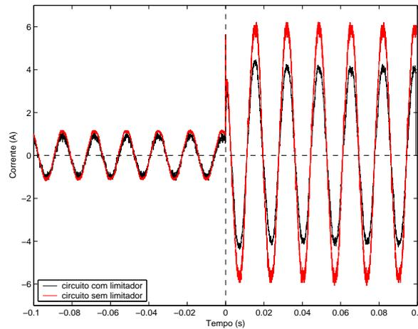
Figura 6.3: Ensaio de curto circuito com o limitador de corrente  $R_{carga} = 20\Omega$  e  $R_{falta} = 4\Omega$ .
