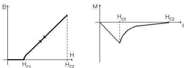
Figura 3.8: Magnetização de supercondutor do tipo II.
