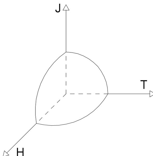
Figura 3.2: Diagrama típico da relação entre Temperatura - Campo Magnético - Densidade de Corrente.
