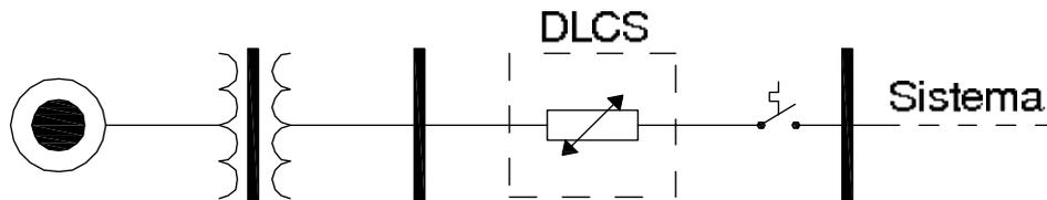
Figura 2.9: Circuito elétrico equivalente de DLCFS do tipo resistivo.
