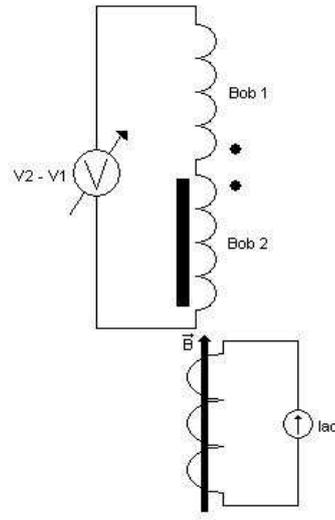
Figura 5.2: Mostra o esquemático de um Susceptômetro.
