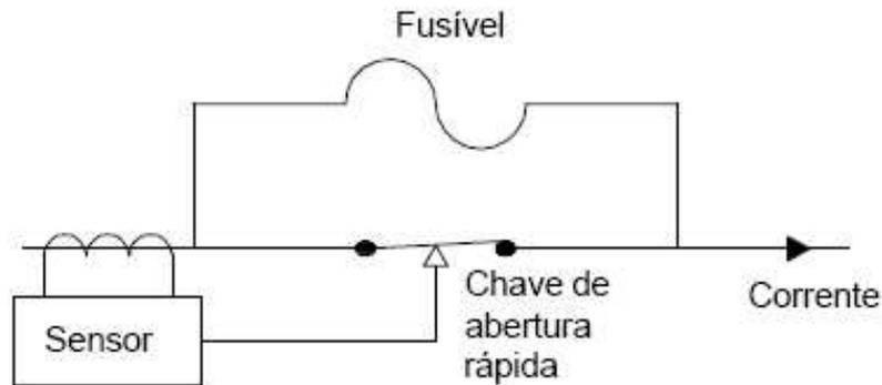
Figura 2.3: Esquema de um limitador de corrente de falta pirotécnico.
