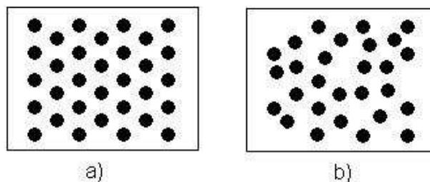
Figura 3.7: Grupo de vórtices vistos por cima. a) Arranjo ordenado triangular, chamado de Rede de Abrikosov, b) arranjo irregular de vórtices.
