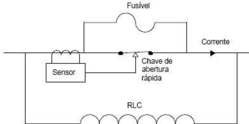
Figura 2.4: Esquema de um limitador de corrente de falta pirotécnico em paralelo com um reator limitador de corrente.
