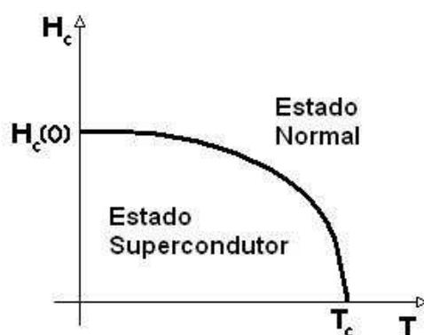
Figura 3.1: Diagrama de fase de um supercondutor.
