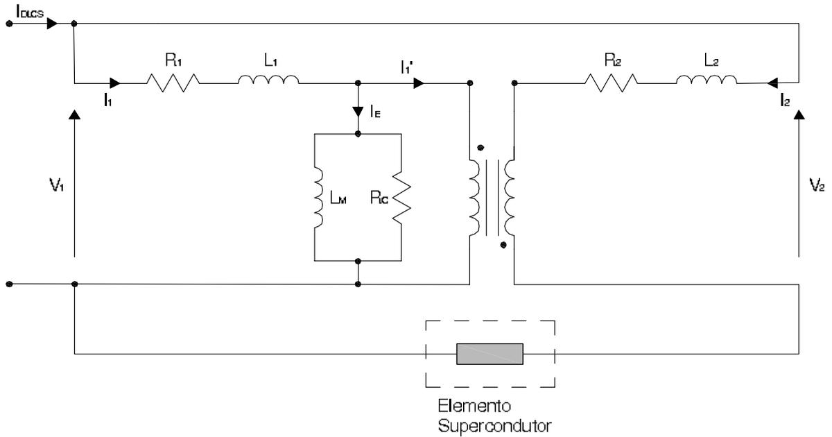
Figura 2.13: Circuito elétrico equivalente de DLCFS do tipo fluxo fechado.
