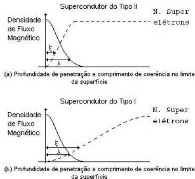
Figura 3.11: Profundidade de penetração e comprimento de coerência no limite da superfície de um supercondutor do tipo I e do tipo II.
