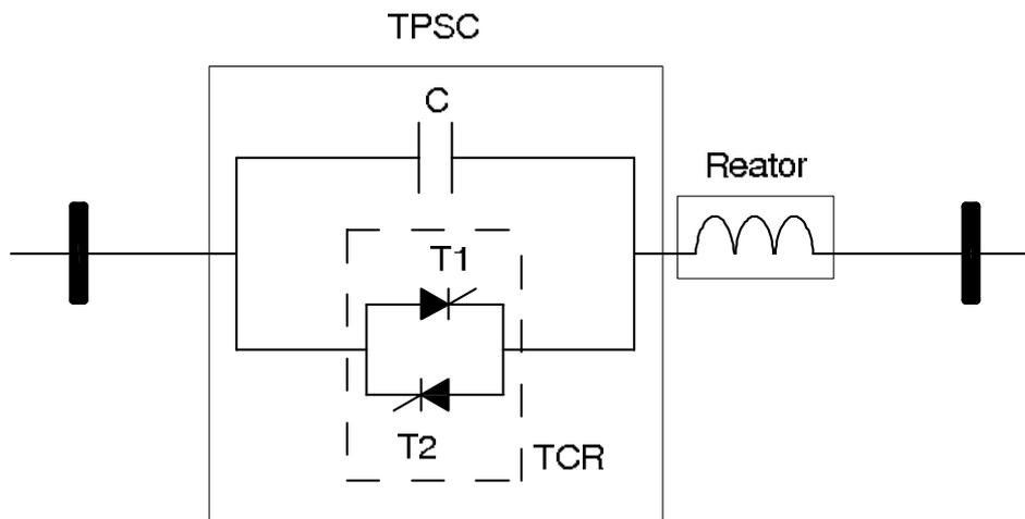
Figura 2.6: Esquema de um dispositivo limitador baseado no TPSC.
