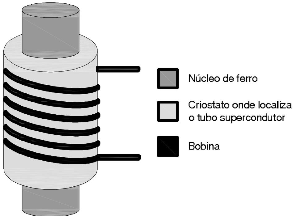
Figura 2.10: Esquemático de um DLCFS tipo indutivo.
