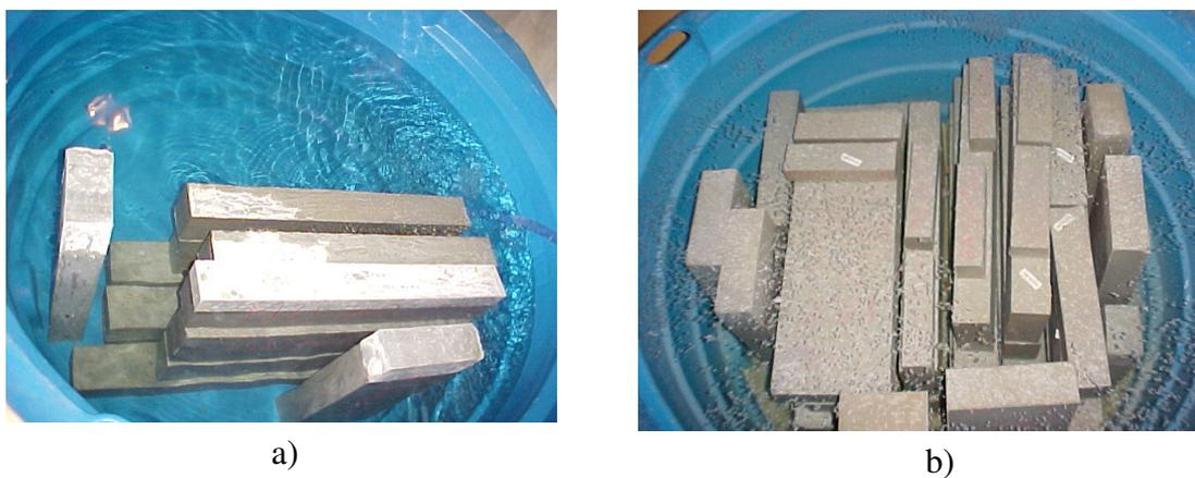
FIGURA 4.12 Processo de cura, vigas submersas em água:
