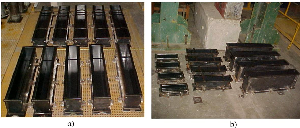
FIGURA 4.4 Fôrmas metálicas, utilizadas na modelagem das vigas:
