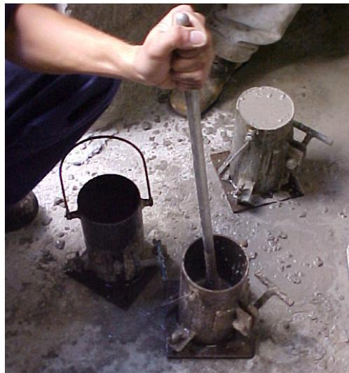
FIGURA 4.8 Modelagem de corpos-de-prova cilíndricos.
