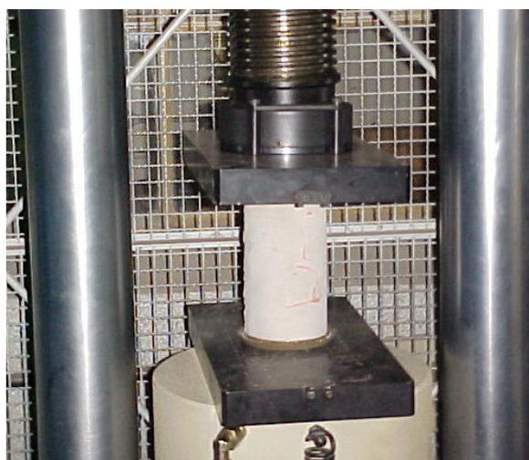
FIGURA 4.13 Ensaio de compressão uniaxial.
