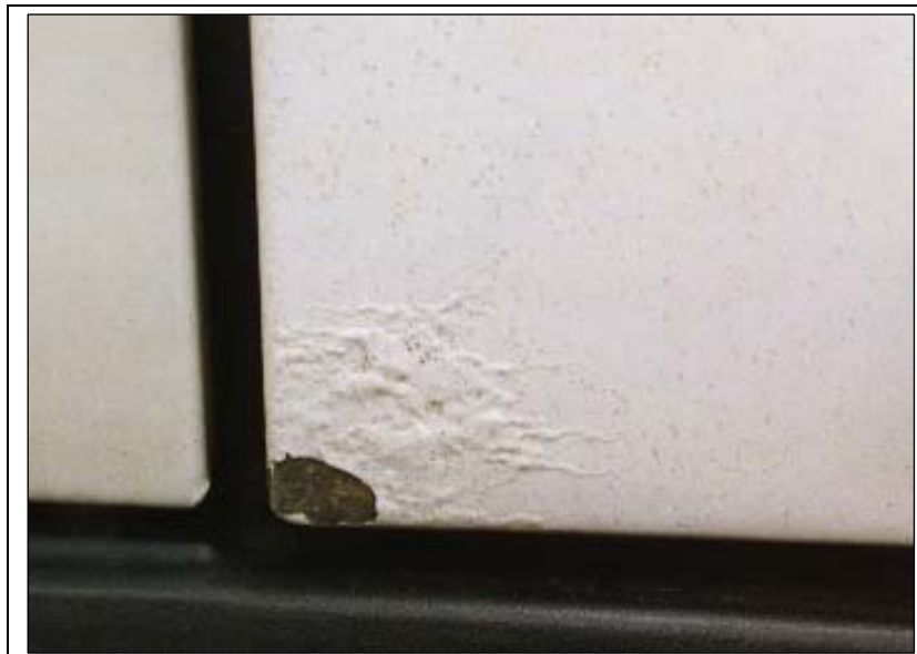
Figura 58 – Corrosão na porta do automóvel da década de 70
