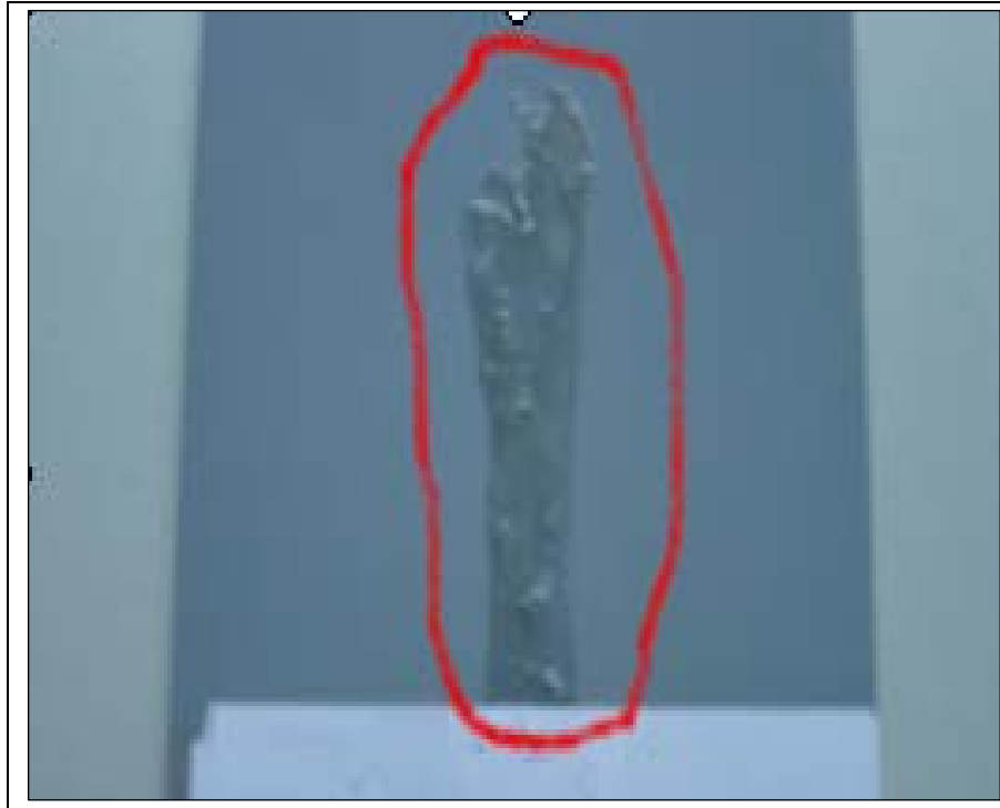
Figura 41 – Depósito de tinta na superfície da placa pintada
