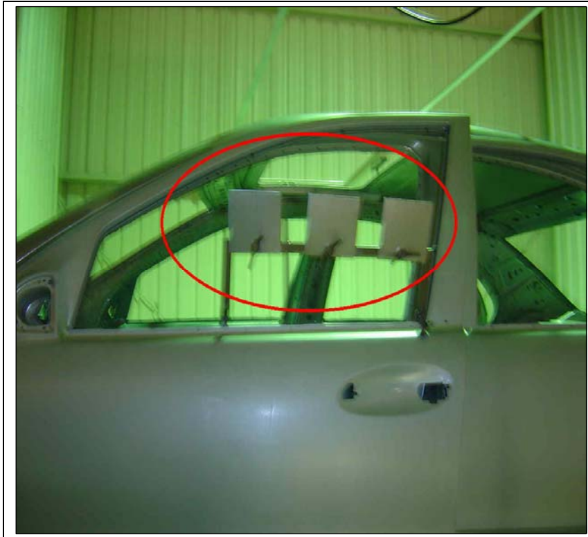
Figura 49 – Corpos de prova fixados a parte superior dianteira
