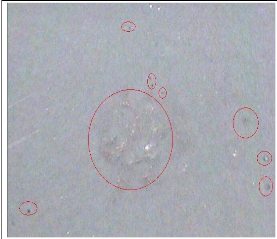
Figura 31 – Chapa revestida contaminada com silicone
