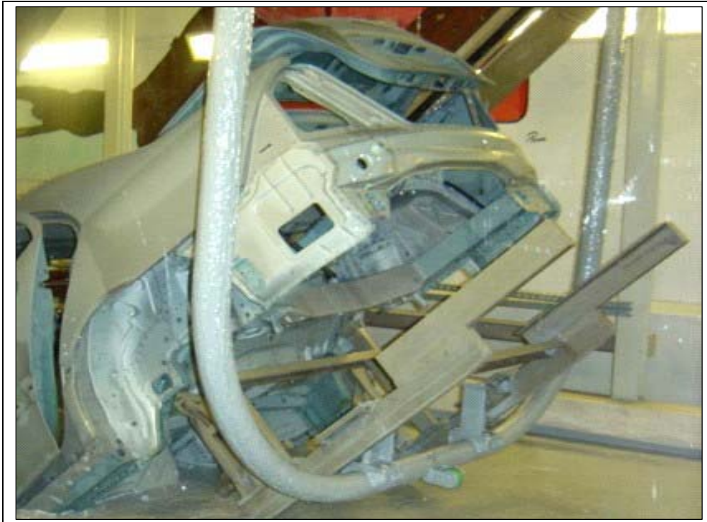
Figura 38 – O pêndulo com a carroceria fixada entrando no banho
