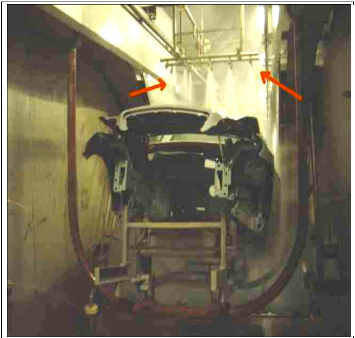
Figura 9 – Lavagem de carroceria com sistema de spray com água deionizada
