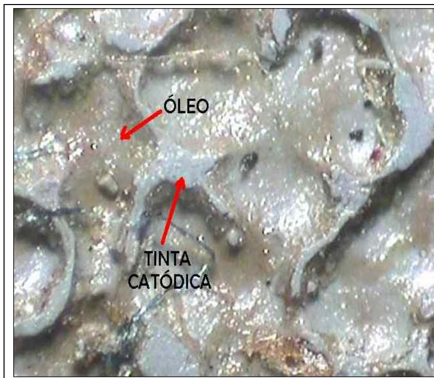
Figura 27 – O aparecimento de cratera devido contaminação de óleo
