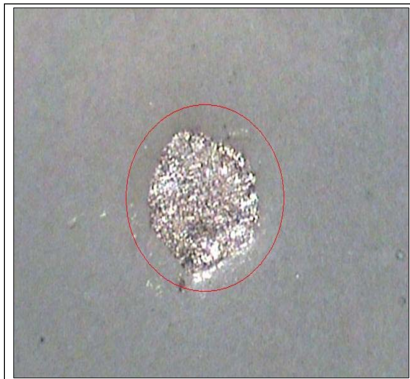
Figura 35 – Detalhe das contaminações da espuma no banho
