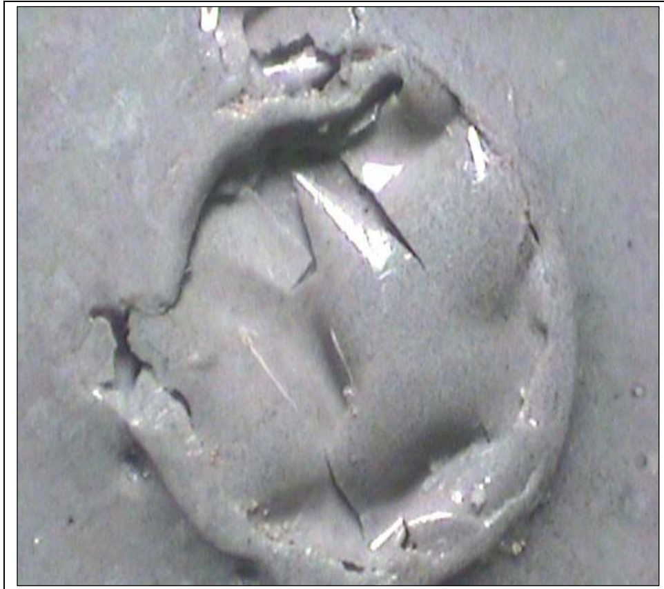
Figura 29 – Detalhe de contaminações provenientes de água contaminada com bactérias e fungos Fonte: A própria autora.
