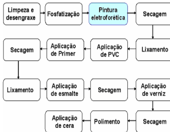
Figura 55 – Fluxograma do processo de pintura das carrocerias
