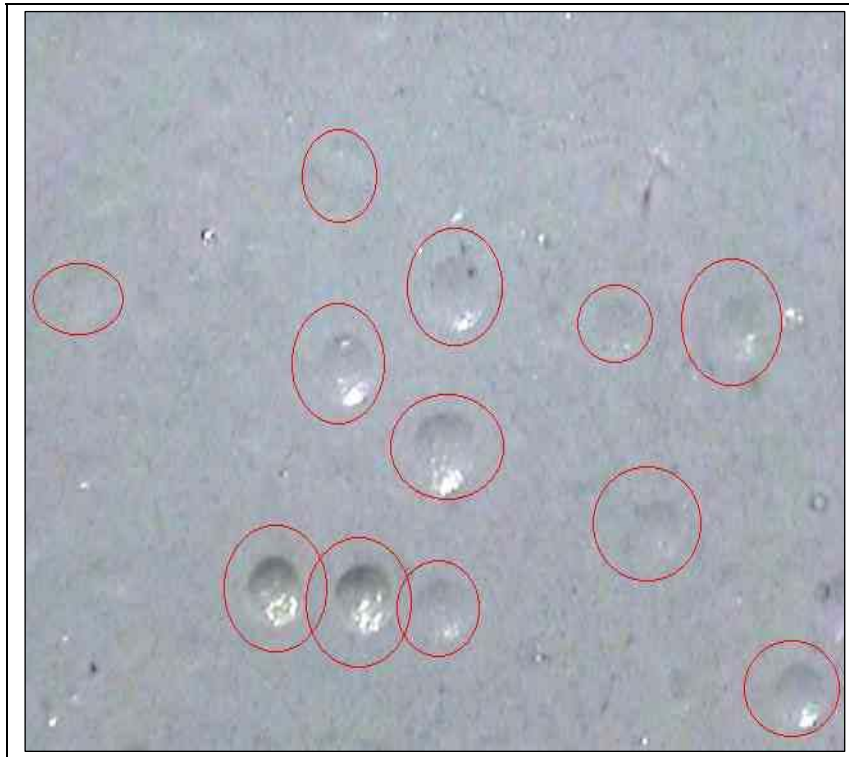
Figura 26 – O aparecimento de crateras na superfície pintada
