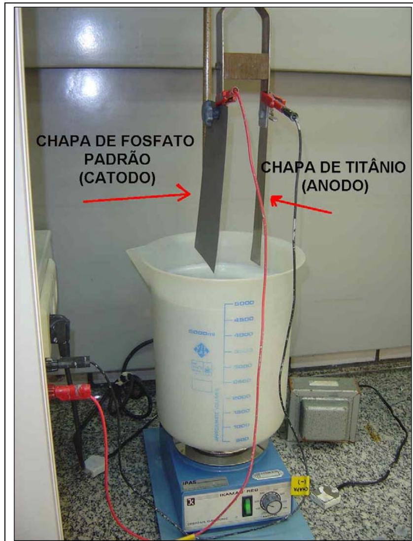
Figura 16 – Início da preparação da tinta eletroforética padrão
