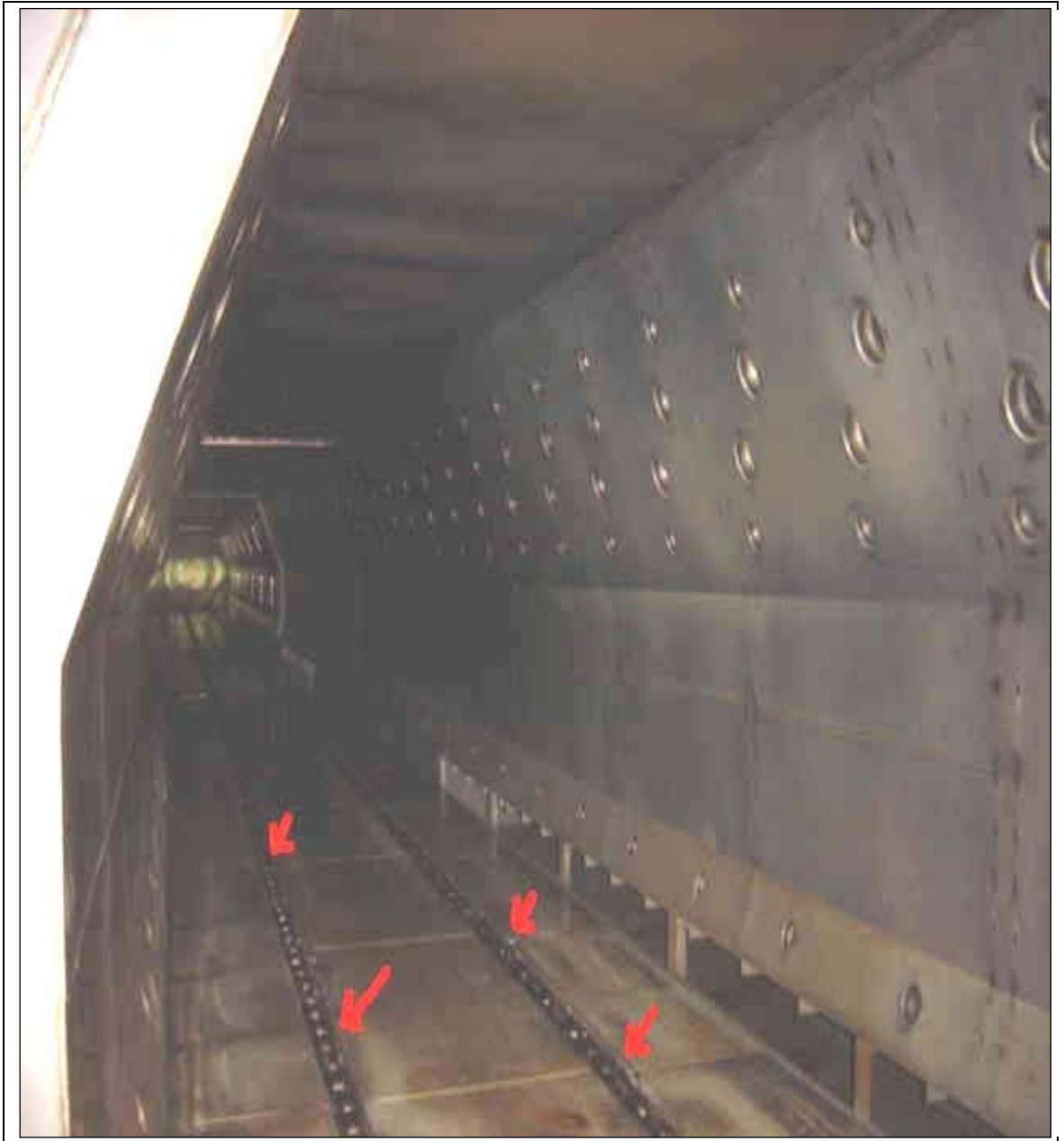
Figura 21 – Os roletes e as correntes no interior do secador das carrocerias
