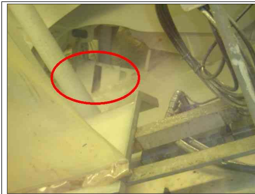
Figura 53 – Corpos de prova saindo do banho de pintura eletroforética Fonte: A própria autora.
