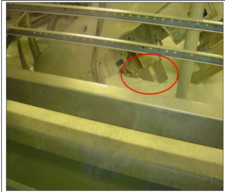
Figura 52 – Corpos de prova entrando no banho de pintura eletroforética Fonte: A própria autora.
