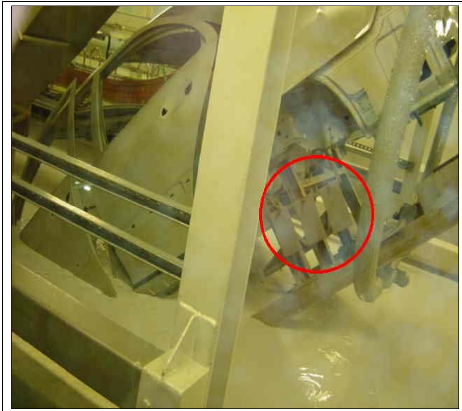
Figura 51 – Corpos de prova entrando no banho de pintura eletroforética
