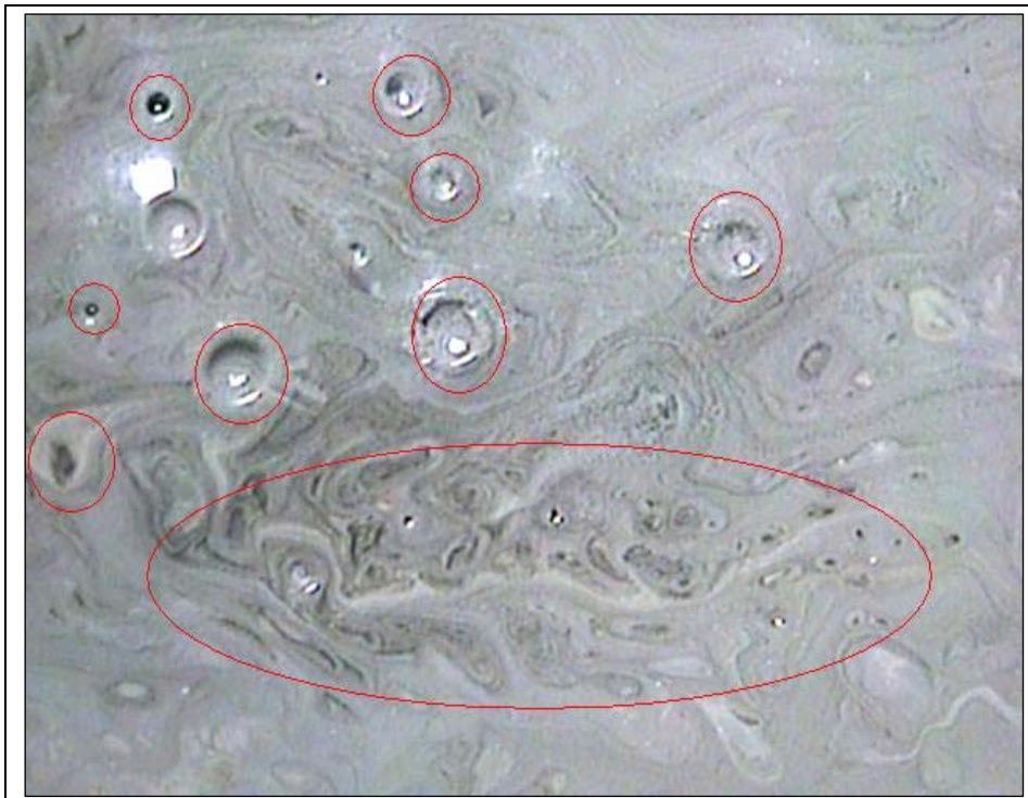
Figura 42 – Detalhe mostrando o depósito da borra de tinta na superfície pintada
