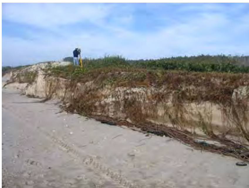
Figura 4.8: Perfil 3 após a tempestade que ocorreu 3 dias antes do levantamento 11 (agosto, 2005). Note a escarpa na duna frontal e afloramento de turfa em sua base.
