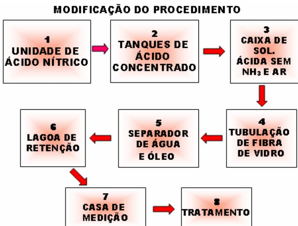
**Figura 38** – Transferência da solução ácida direto para lagoa ou S.A.O. sem neutralização com amônia
