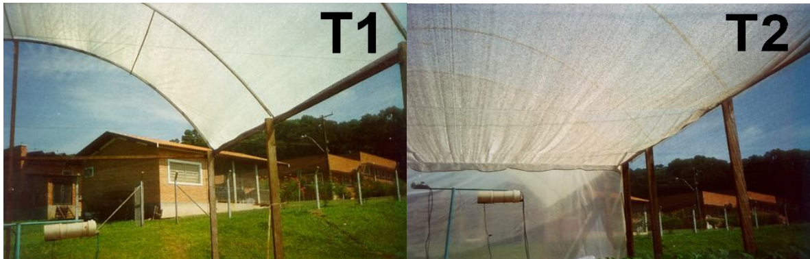
Figura 7 - Vista interna dos tratamentos adotados no presente estudo: Ambiente 1 (T1) - termo-refletores externa; Ambiente 2 (T2) - termo-refletores interna (dentro do ambiente protegido). Piracicaba, SP, 2004
