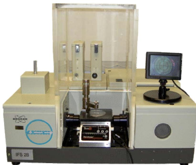
Figura 17 – Espectrômetro FT-IR Bruker IFS28.
