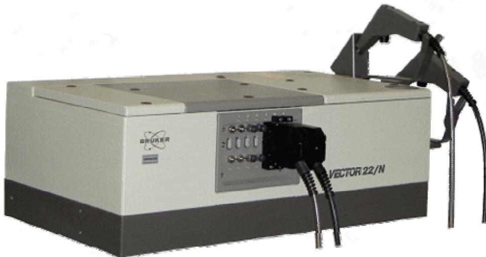
Figura 19 – Espectrômetro FT-NIR , Bruker VECTOR 22/N.
