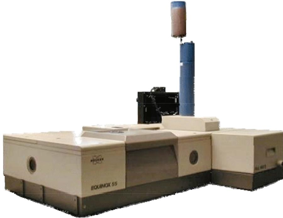
Figura 18 – Espectrômetro de Bruker Equinox 55 FTIR com o módulo de FT-Raman FRA 106.
