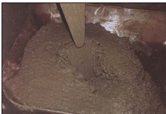
Figura A.2 – Aspecto homogêneo do concreto com teor de argamassa ideal.
