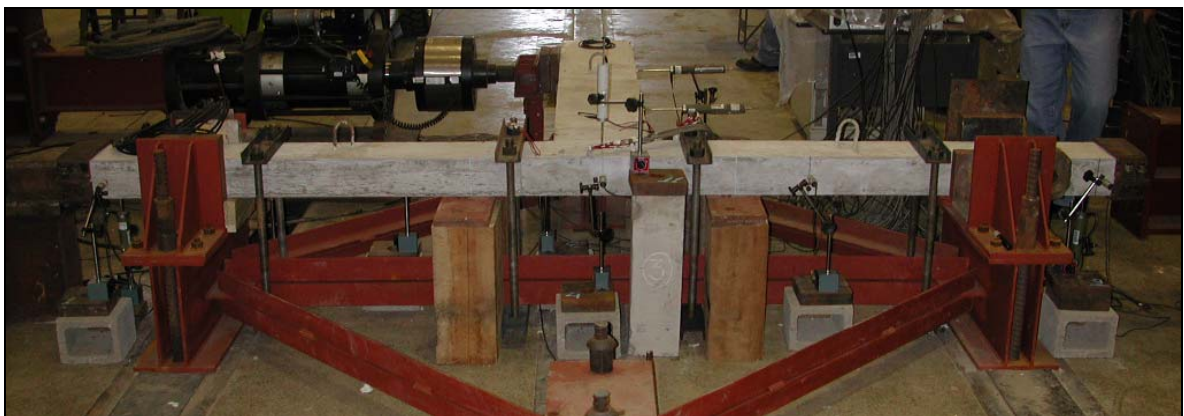
Figura 4.13 – Apoios utilizados para a redução do índice de esbeltez da peça (Ensaio Definitivo).
