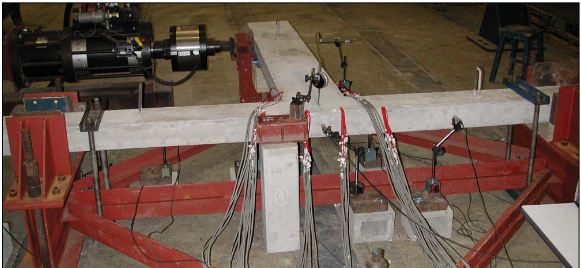
Figura 4.12 – Tirantes utilizados para a redução do índice de esbelteza da peça (Ensaio Piloto).
