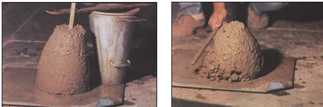
Figura A.3 – Aspecto compacto e coeso do concreto com teor de argamassa ideal.
