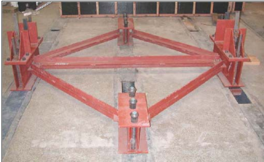
Figura 4.6 – Quadro horizontal auto-equilibrado.
