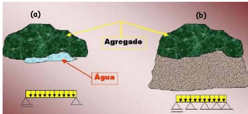
Figura 34. Idealização do comportamento de agregados em concretos com e sem sílica ativa: (a) fenômeno da exsudação interna em agregados de forma alongada ; (b) agregado confinado - processo de dopagem com sílica ativa. Fonte: Liborio (2003).
