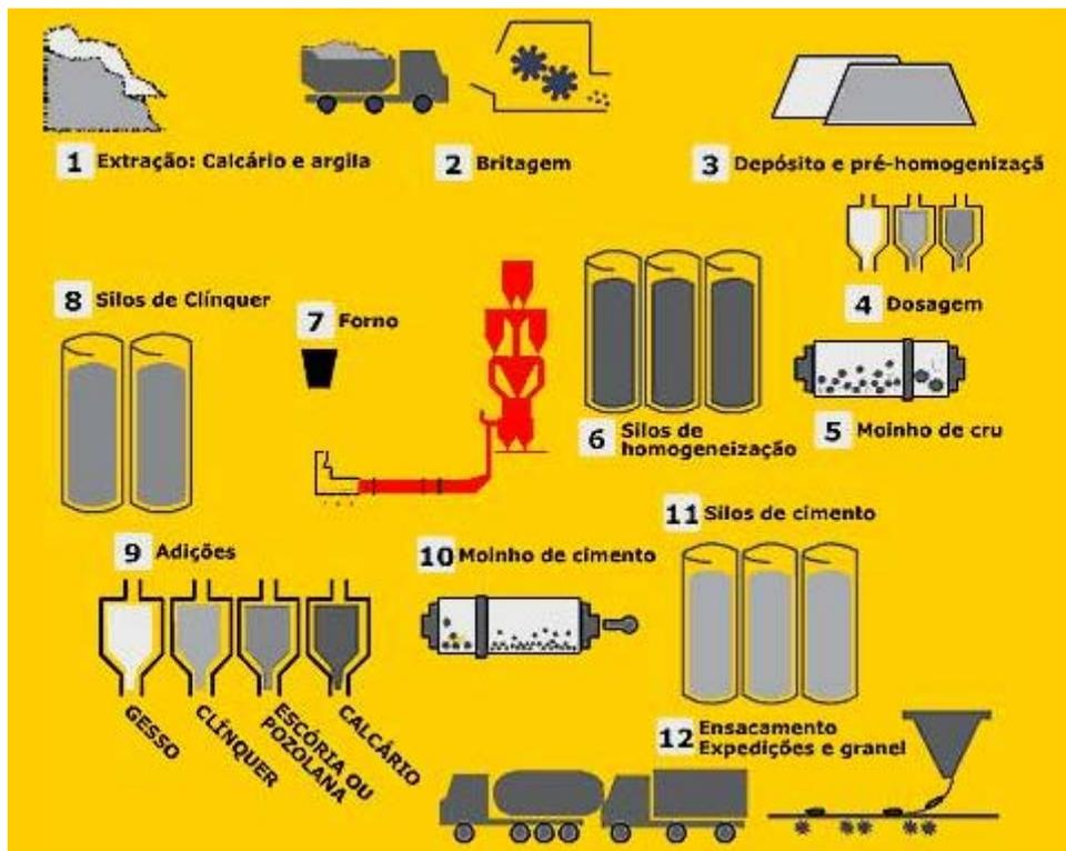
Figura 16. Esquema do processo de fabricação do cimento Portland. Fonte: <http://www.abcp.org.br>
