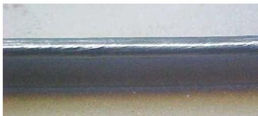
Figura 11.1: Cordão obtido na velocidade limite com a mistura A50 comercial (gás de plasma e proteção)
