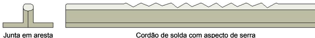
Figura 2.7: Formato esquemático característico de cordões de solda com aspecto de serra (baseado em Shneerson & Bykhovskii, 1980)
