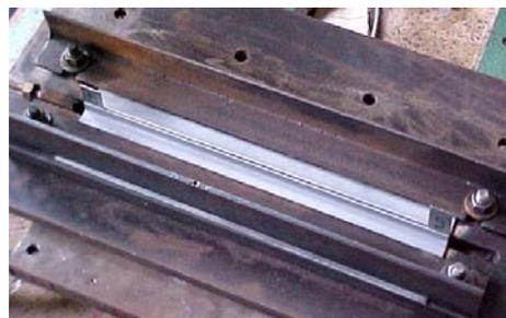
Corpo de prova com espaçadores
