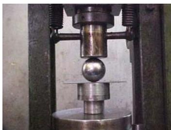
Corpo de prova sem deformação
