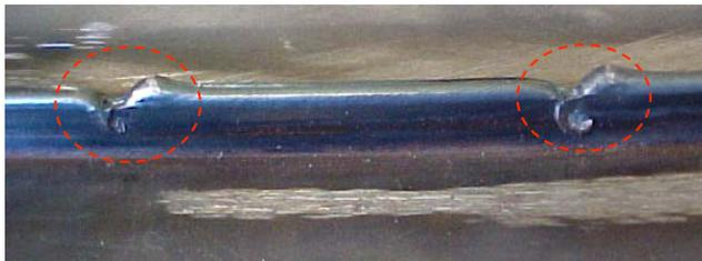
Figura 3.9: Descontinuidades sobre pontos de solda por resistência
