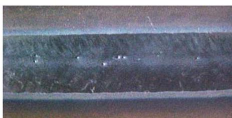
Figura 14.8: Junta sobreposta com poros (mistura A100 e elevada velocidade de soldagem)
