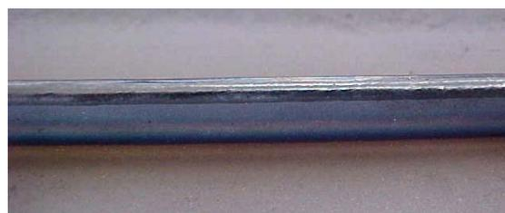
Figura 8.8: Trecho de cordão totalmente conforme com a mistura A40
