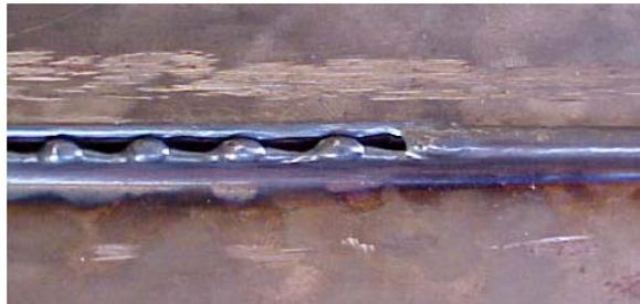
Figura 3.12: Exemplo de junta que se abriu durante o processo de soldagem
