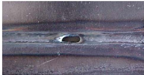
Figura 7.4: Detalhe da perfuração no cordão de solda
