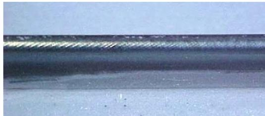
Figura 9.5: Aspecto do cordão obtido com a fonte de soldagem “Ultima 150” (teste 25-1-2)
