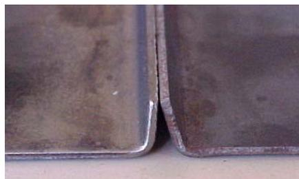
Figura 3.13: Detalhe da junta pré-deformada
