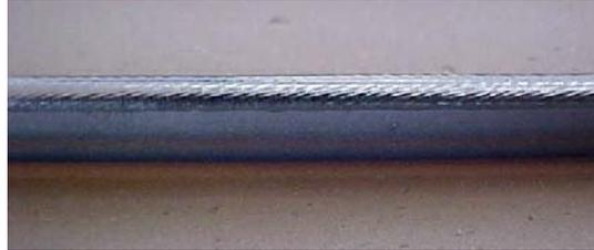
Figura 8.7: Trecho de cordão totalmente conforme com a mistura A30
