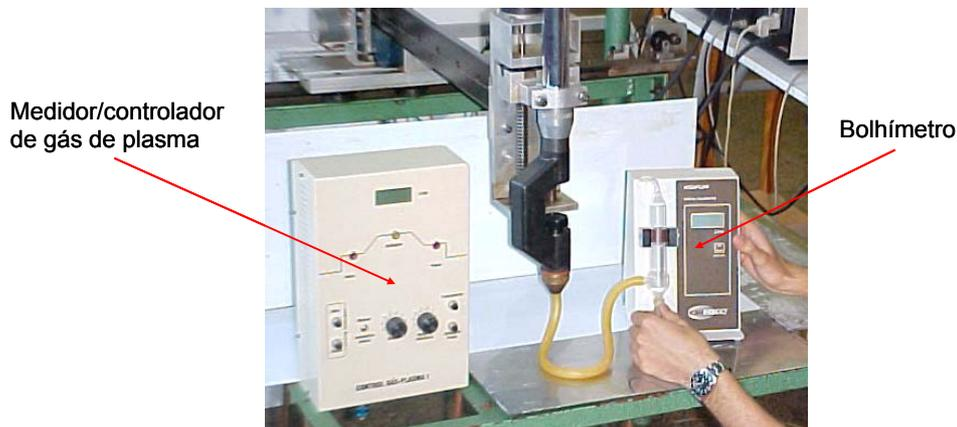
Figura 3.5: Arranjo experimental para calibração do medidor/controlador de gás de plasma
