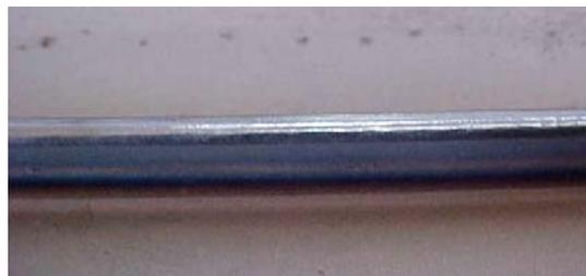
Figura 8.9: Trecho de cordão totalmente conforme (velocidade de 1700 mm/min)
