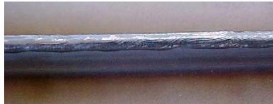
Figura 8.6: Trecho de cordão totalmente conforme (mistura A20)
