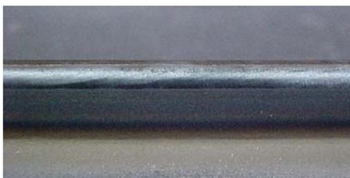
Figura 14.2: Cordão obtido no limite da velocidade de soldagem da série 33-2
