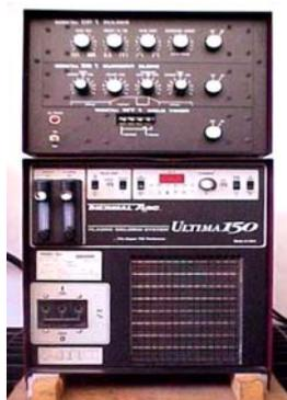
Fonte de soldagem (abaixo) e módulo auxiliar (acima)
