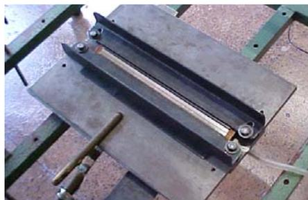
Figura 7.2: Suporte de fixação do corpo de prova
