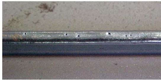
Figura 8.11: Cordão com pequenos poros provocados pelo elevado teor do aditivo B (mistura A30B30)
