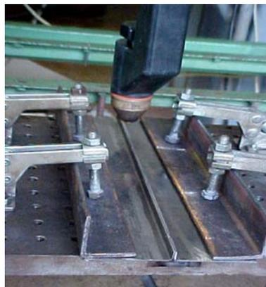
Figura 3.7: Suporte de fixação do corpo de prova
