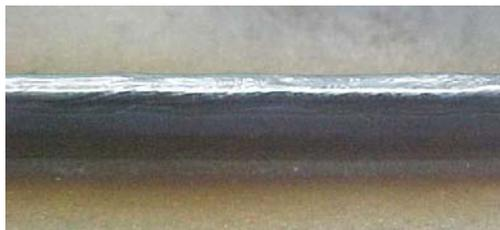
Figura 11.2: Cordão obtido na velocidade limite usando a mistura A50 comercial (proteção) e Ar (plasma)
