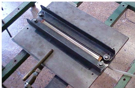
Figura 6.2: Suporte de fixação do corpo de prova
