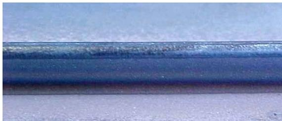
Figura 10.3: Aspecto do cordão de solda obtido nos testes 27-1-3, 27-1-5 e 27-1-6
