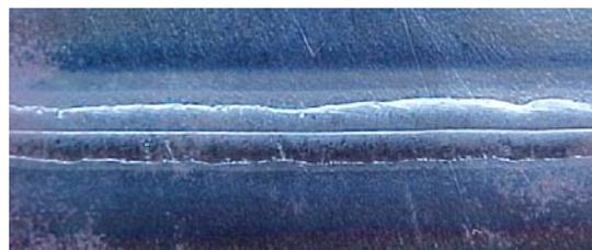
Figura 6.8: Raiz de solda resultante da penetração excessiva do arco sobre a junta
